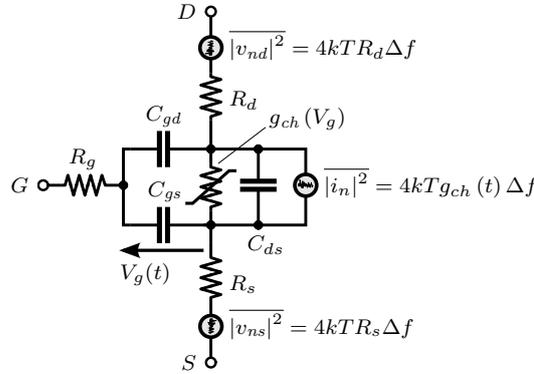
**Figure 2.2** – Modèle simplifié d'un transistor NMOS froid.
