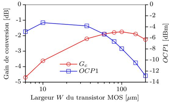
**Figure 2.34** – Optimisation de la géométrie du transistor MOS.
