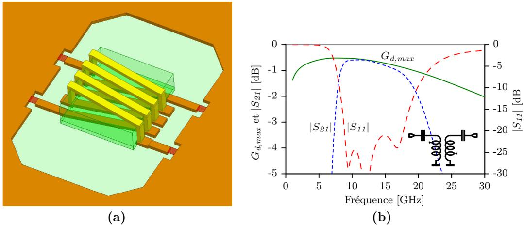
**Figure 3.25** – (a) Modèle 3-D d'un transformateur à solénoïde 2:2, (b) Simulation électromagnétique du  $G_{d,max}$  à vide et des paramètres  $S$  obtenus avec un condensateur d'adaptation placé sur chaque accès.
