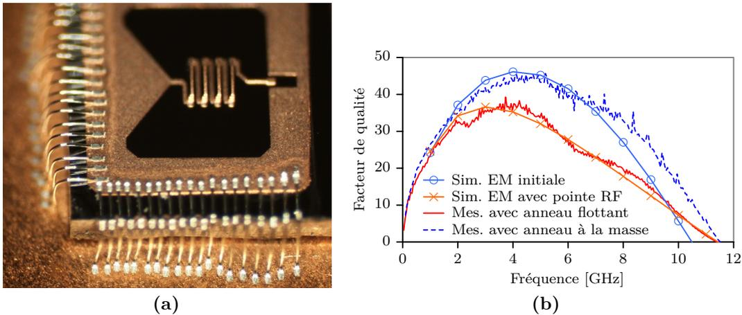
**Figure 3.24** – Expérience supprimant le rayonnement parasite constaté expérimentalement : (a) photographie illustrant l'expérience réalisée, (b) facteurs de qualité simulés et mesurés avant et après la mise en place des fils micro-soudés.
