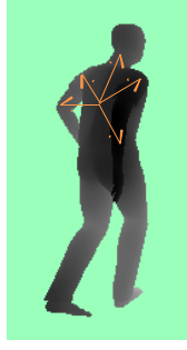
Figure 3-6: Différents "offsets" sur la position des articulations à partir d'un pixel du dos.
