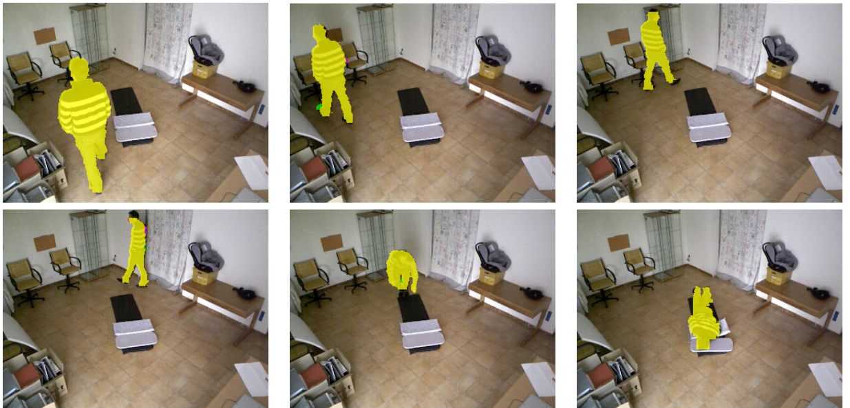
Figure 2-9: Segmentation d'une séquence de marche et chute.
