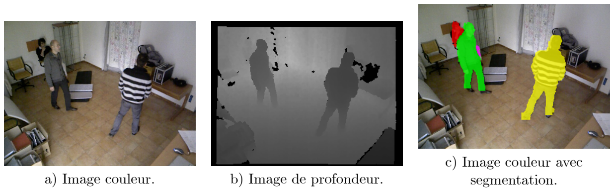
Figure 2-11: Segmentation de plusieurs personnes avec occultation.
