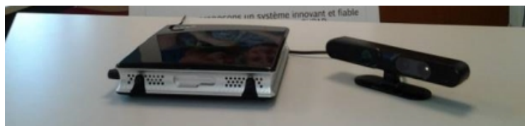
Figure 5-1: Capteur et ordinateur constituant notre prototype de système de détection.
