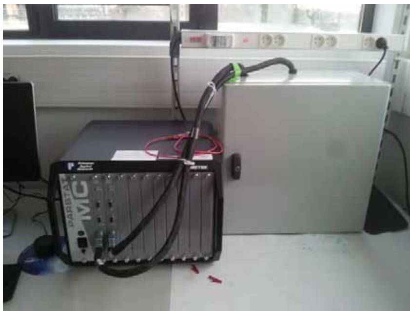
Figure 3 : photographie montrant la disposition de la cage de Faraday par rapport au potentiostat pour le cas des mesures I(t) et I(V) .
