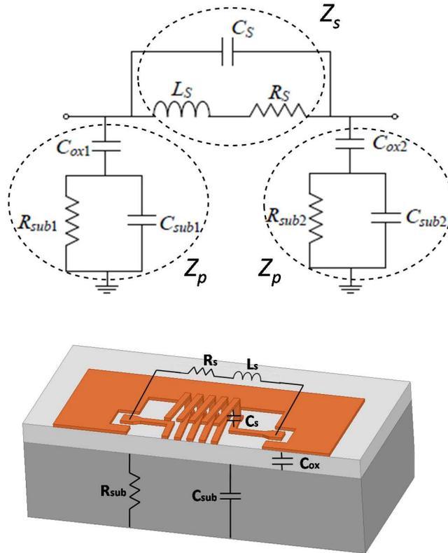
Figure II.4 : schéma électrique équivalent d'une inductance.
