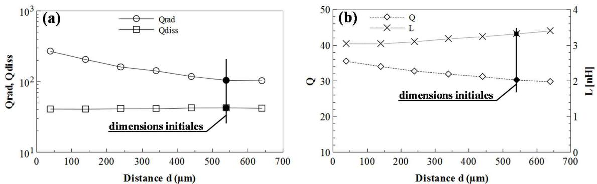
Figure III.19 : (a) effet de la distance  $d$  qui sépare l'inductance de l'anneau métallique sur  $Q_{rad}$  et  $Q_{diss}$ , (b) le facteur  $Q$  et l'inductance  $L$  à 5GHz.
