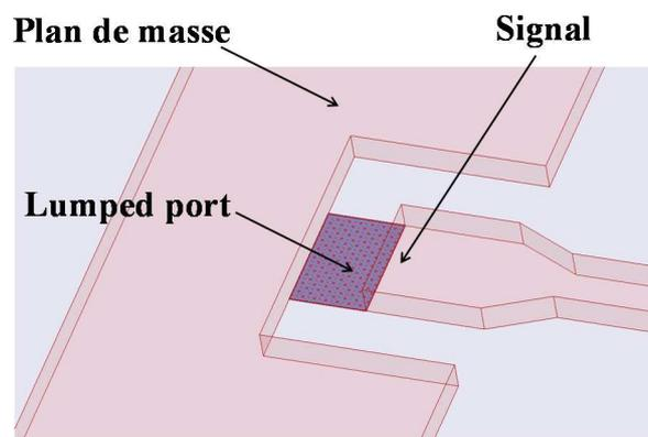
Figure II.3 : définition de Lumped port sous HFSS.
