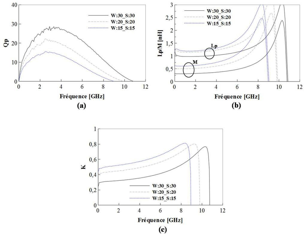
Figure IV.10 : (a) facteur de qualité  $Q_p$ , (b) inductance  $L_p$  de l'enroulement primaire et inductance mutuelle  $M$ , (c) coefficient de couplage  $K$ , mesurés en fonction de la fréquence pour les différents dimensionnements de transformateur de 2 tours.
