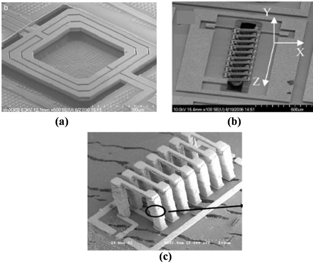
Figure I.14 : micrographies de transformateur (a) spiral [27] et (b) solénoïdal [29] réalisé au-dessus d'une cavité. (c) Micrographies d'inductance réalisée à l'aide de technique Flip-Chip [39].
