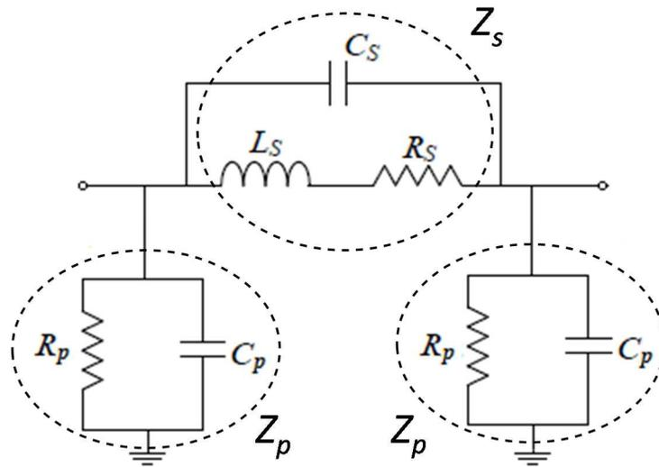
Figure II.5 : schéma électrique équivalent simplifié d'une inductance.
