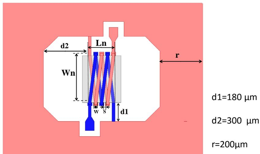
Figure II.19 : vue de dessus du transformateur sous HFSS.
