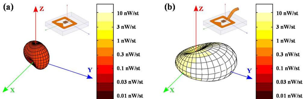
Figure III.10 : intensité du rayonnement à 5 GHz du solénoïde exprimée en nWatt / stéradian. Simulation avec un port interne (a) et avec une pointe RF (b).
