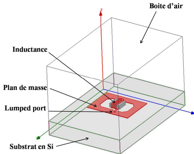
Figure II.2 : modèle de simulation de l'inductance sous HFSS.
