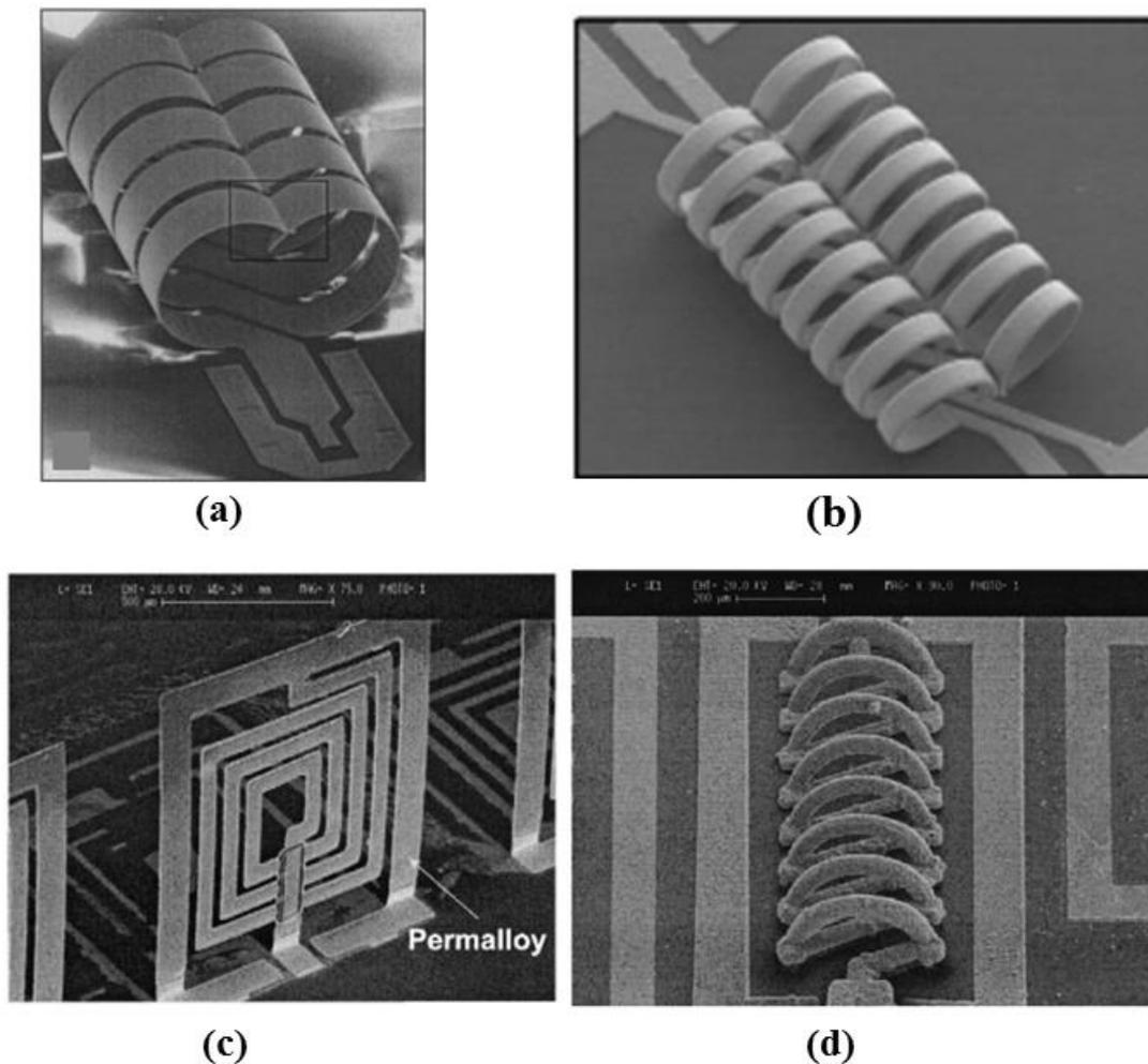
Figure I.12 : micrographies (a) d'inductance 3D [31] et du (b) transformateur 3D [32] réalisés à l'aide de technique « métal stress », et d'inductances spirale (c) et solénoïde (d) réalisées à l'aide de technique PDMA [33].
