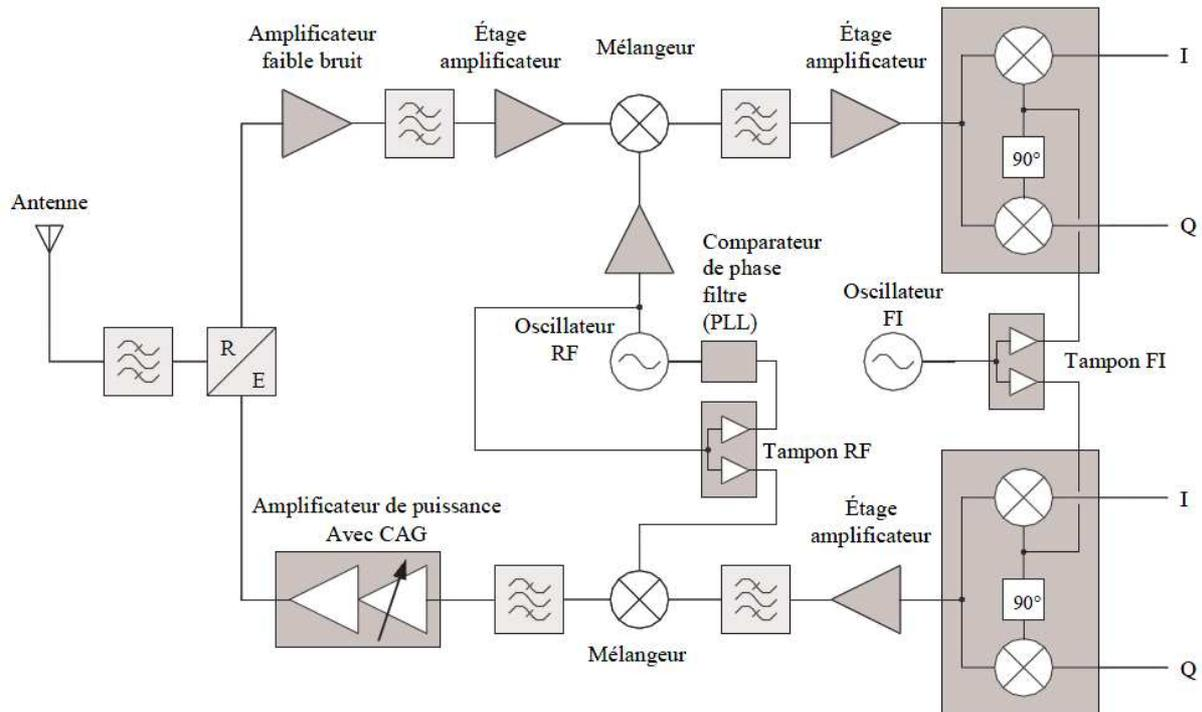
Figure I.4 : architecture d'un émetteur/récepteur superhétérodyne conventionnel [1].
