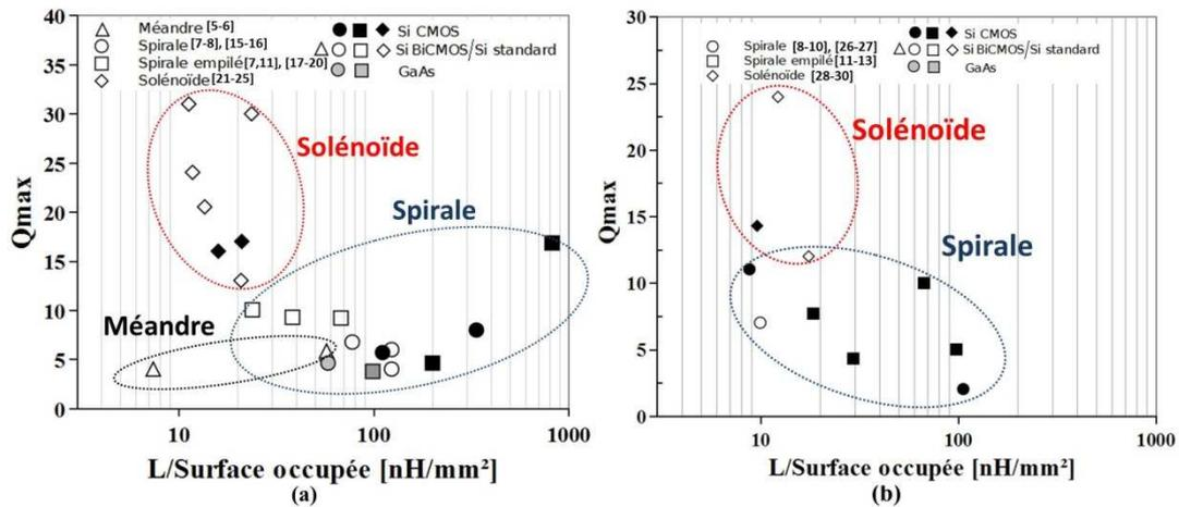
Figure I.11 : état de l'art pour les inductances (a) et les transformateurs (b) RF intégrés représenté sous la forme du facteur de qualité maximal  $Q_{max}$  en fonction de la valeur d'inductance  $L$  par unité de surface occupée.
