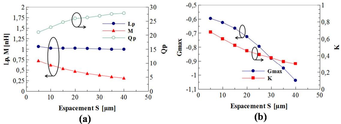
Figure II.21 : variations (a) de l'inductance  $L_p$  et mutuelle  $M$ , le facteur  $Q_p$ , (b) de coefficient de couplage  $K$  et le gain maximum disponible  $G_{\text{max}}$  à 2 GHz en fonction de l'espacement entre les spires  $S$ .
