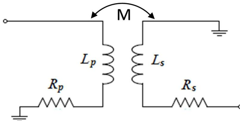
Figure II.17 : modèle de transformateur à 2 accès.
