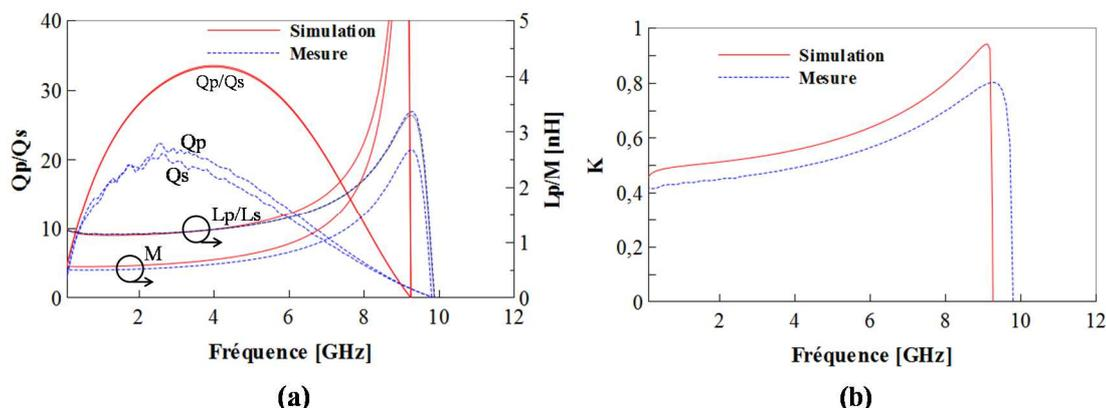
Figure IV.9 : (a) facteur de qualité  $Q_p/Q_s$  et inductance  $L_p/L_s$  de l'enroulement primaire/secondaire et inductance mutuelle  $M$ , (b) coefficient de couplage  $K$  mesuré et simulé en fonction de la fréquence pour le transformateur W:20\_S:20\_2.
