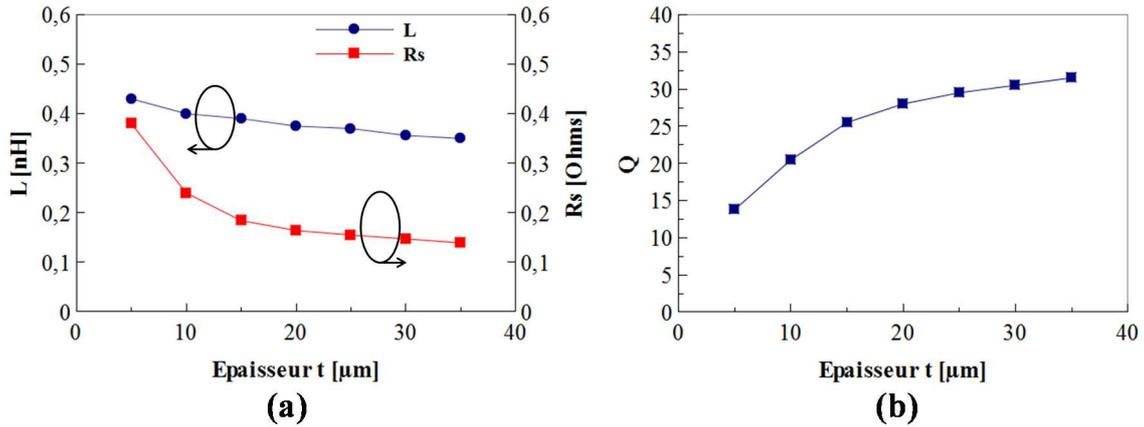
Figure II.8 : variations (a) de l'inductance  $L$ , de la résistance série  $R_s$  et (b) du facteur de qualité  $Q$  à 2 GHz en fonction de l'épaisseur de conducteur  $t$  (inductance de 1 tour,  $W=30 \mu\text{m}$ ).
