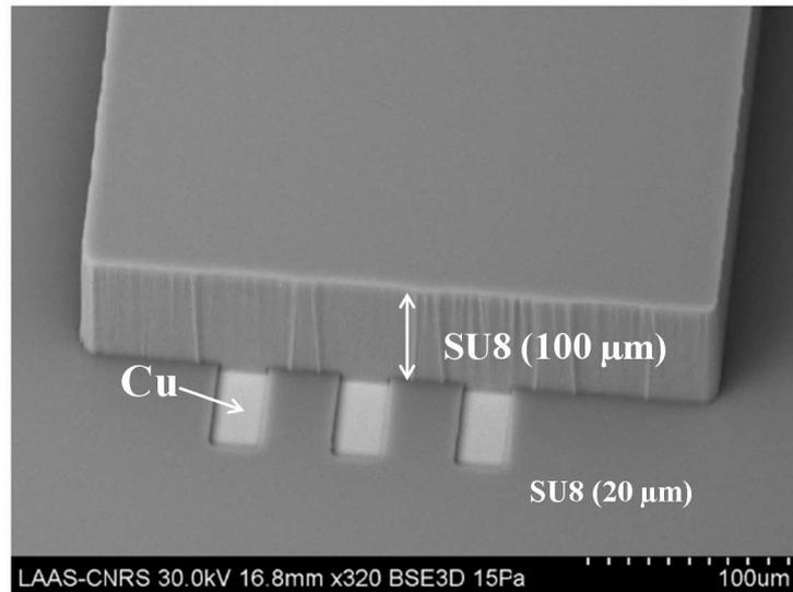
Figure IV.2 : microphotographie MEB d'un plot de SU8 (100  $\mu\text{m}$ ) fabriqué sur une couche de SU8 (20  $\mu\text{m}$ ) avec les ouvertures pour les prises de contact sur le premier niveau métallique.
