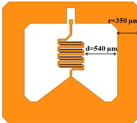
Figure III.17 : solénoïde avec les dimensions initiales.
