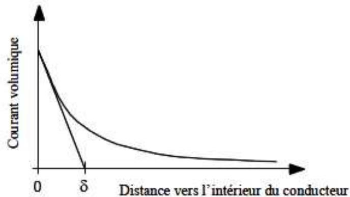
Figure II.1 : densité de courant à l'intérieur d'un conducteur.
