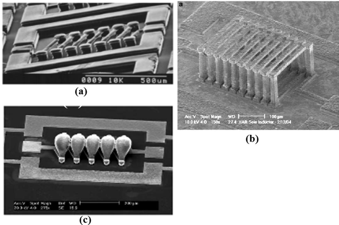
Figure I.13 : micrographies d'inductances micro-usinées (a) [24], (b) [35], (c) [34].
