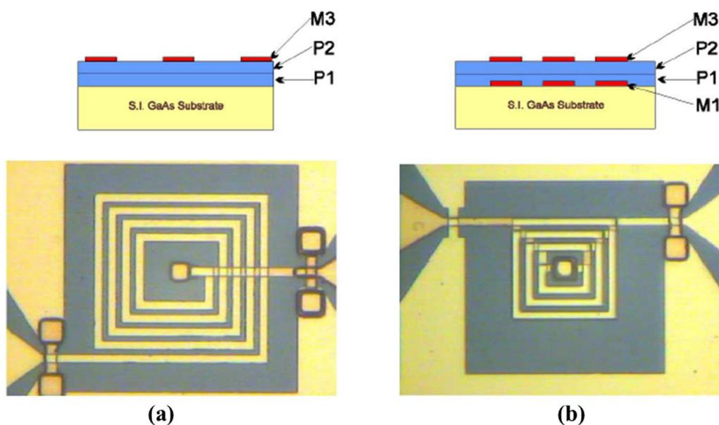
Figure I.9 : vue en coupe et vue de dessus de l'inductance de type (a) spirale planaire et (b) spirale multicouche [7]. (Les indications  $M_i$  et  $P_j$  représentent les niveaux de métal et les niveaux d'isolation en polyimide respectivement).
