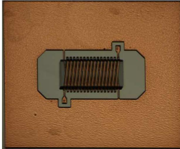
Figure IV.22 : photographie optique de transformateur W:20\_S:20\_8.
