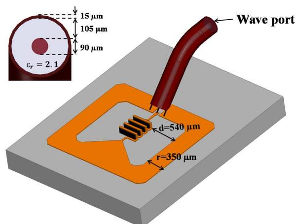
Figure III.7 : modèle de l'inductance avec la pointe RF.
