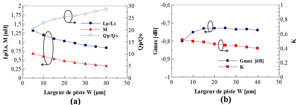
Figure II.20 : variations (a) de l'inductance  $L_p/L_s$  et de l'inductance mutuelle  $M$  (b) du facteur  $Q_p/Q_s$ , du coefficient de couplage magnétique  $K$  et du gain maximum disponible  $G_{\text{max}}$  à 2 GHz en fonction de la largeur de piste  $W$ .
