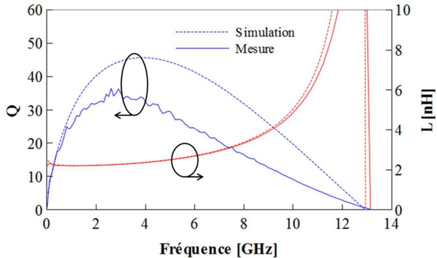
Figure IV.5 : facteur de qualité  $Q$  et inductance  $L$  en fonction de la fréquence.
