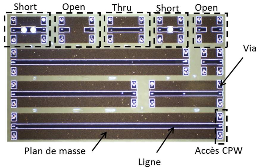
Figure IV.13 : structures micro-rubans réalisées sur le film sec.
