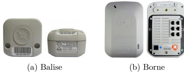
FIGURE 2.2 – Composants du système physique de captation.
