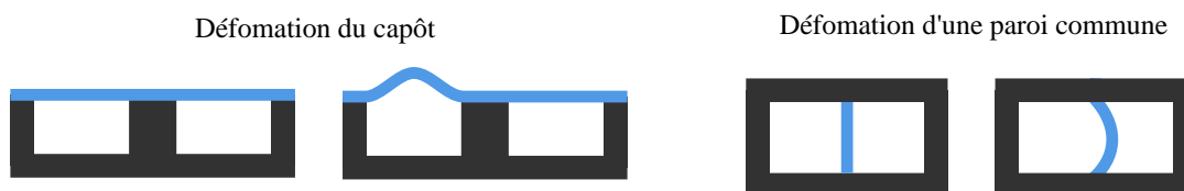
FIGURE 3.38 – Différence entre la configuration de capôt déformable ou de paroi intermédiaire déformable. Dans le second cas, l'ouverture d'un pore provoque la fermeture de son voisin.
