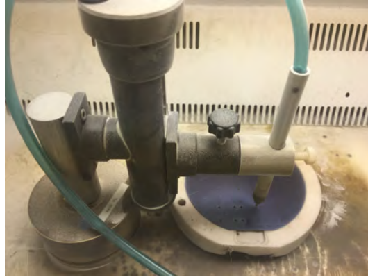
FIGURE 2.8 – Perçage des trous d'alimentation à la microsableuse (Photographie prise par J. Bekhit, stagiaire M2R au LAAS).
