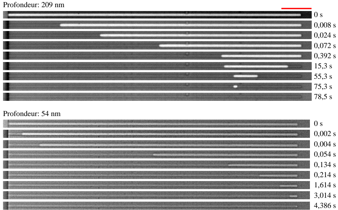
FIGURE 3.18 – Comparaison de la cinétique d’imbibition de nanocanaux en impasse de 209 nm et 54 nm de profondeur. L’échelle de longueur représente 100 \mu\text{m} .
