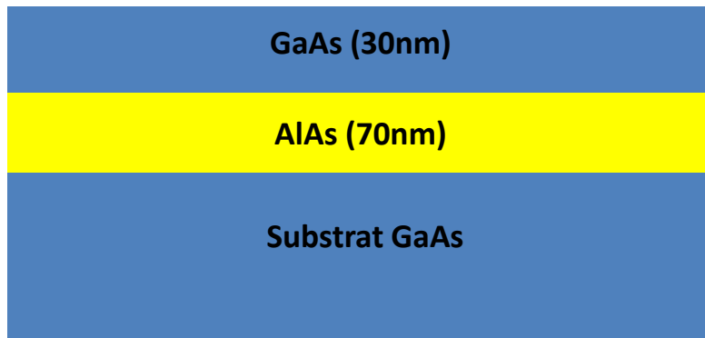
Figure II.19: Schéma de la structure de l'échantillon 2209 utilisé
