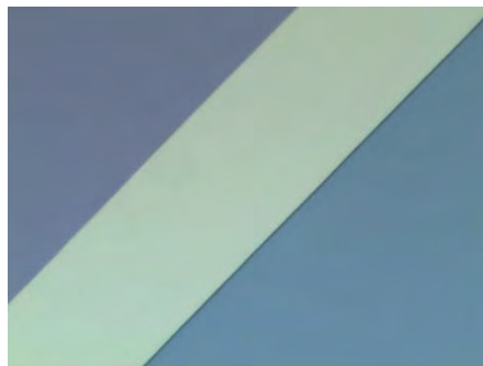
Figure I.13 : Image au microscope optique d'un mesa planaire
