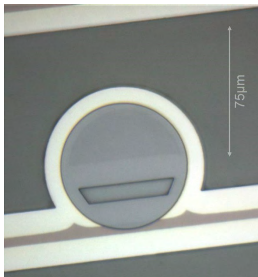
Figure IV. 13 : Image au microscope optique d'un micro-disque de 75 µm de diamètre (Calvez, et al., 2015)
