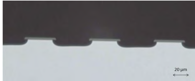
Figure IV. 32 : Vue en coupe d'une gravure au dichromate de potassium d'un échantillon de GaAs surmonté de résine
