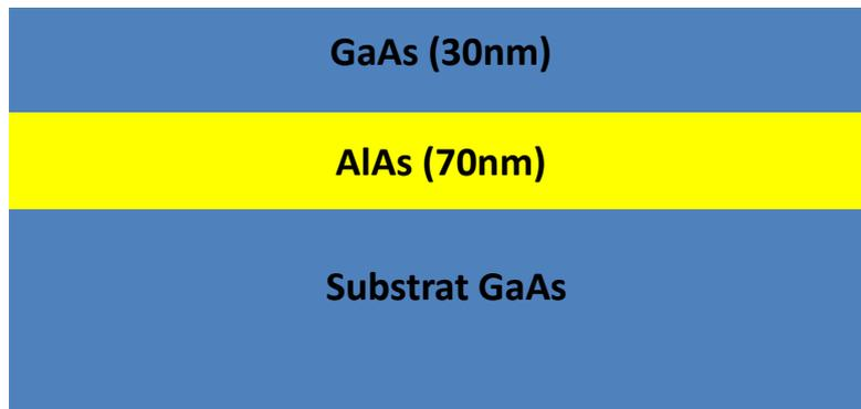
Figure II.19: [Schéma de la structure de l'échantillon 2209 utilisé](#)
