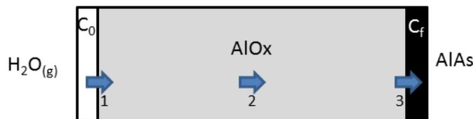
Figure II.4 : Trajet de l'oxydant (H<sub>2</sub>O) à travers l'oxyde (AlOx)
