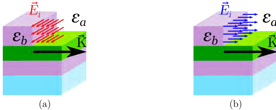
Figure 1.2 – Représentation graphique de la biréfringence sous l'incidence normale ( \theta_i = 0^\circ ) : (a) pour la polarisation \vec{s} avec moyenne géométrique \epsilon_{\perp} et (b) polarisation \vec{p} avec moyenne harmonique \epsilon_{//} .
