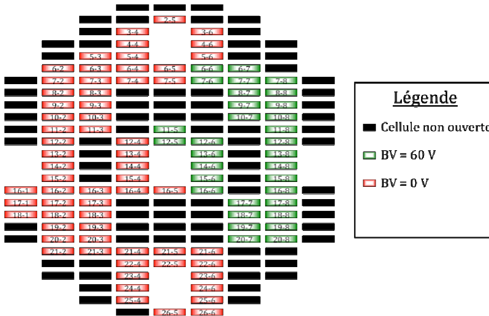
Figure IV.14 : Cartographie des mesures effectuées sur l'ensemble du wafer
