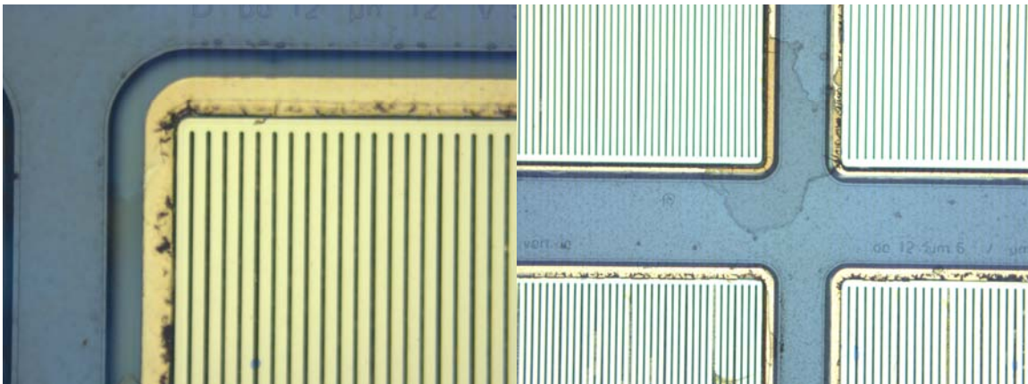
Figure IV.10 : Photographie par microscope des composants après gravure du métal
