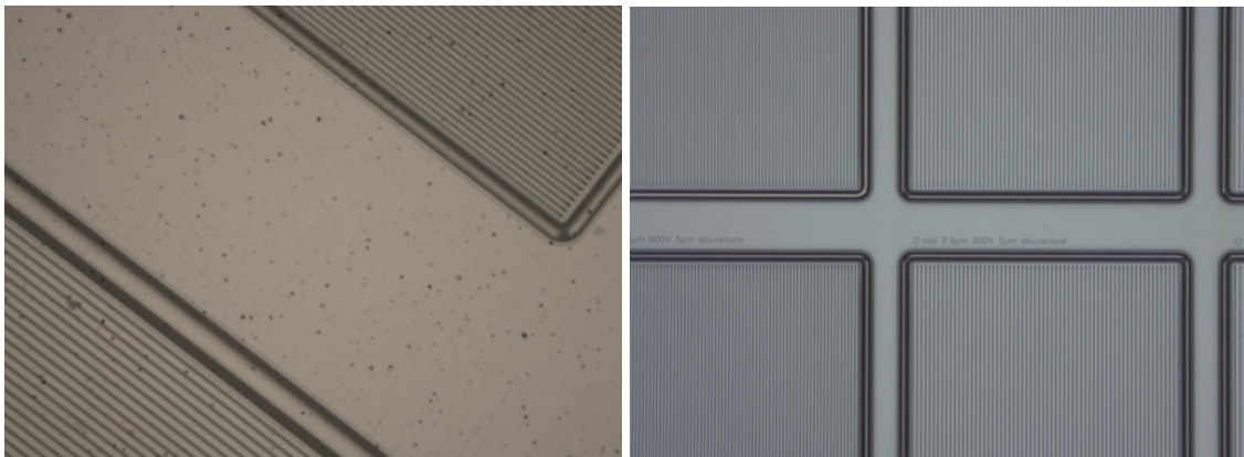
Figure IV.7 : Etat de surface du BCB après dépôt, planarisation (à gauche) et recuit thermique à 210°C (à droite)
