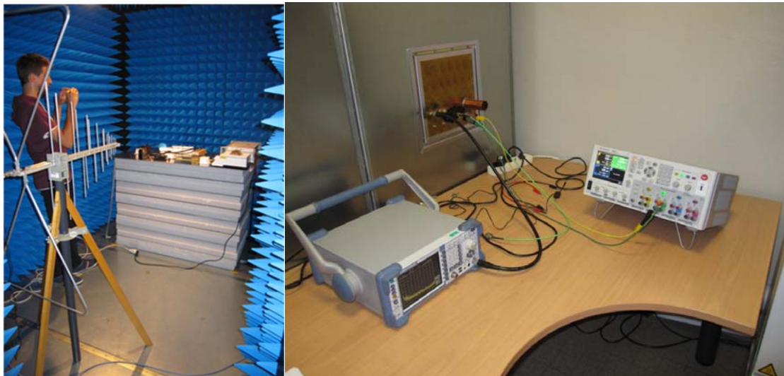
Figure 164 - Configuration de l'environnement de mesure : dans la cage (à gauche) et hors de la cage (à droite)
