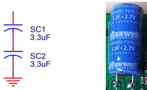
Figure I47: Vue détaillée de la partie stockage du HMEC avec une photo d'un supercondensateur Maxwell BCAP0003 utilisé.
