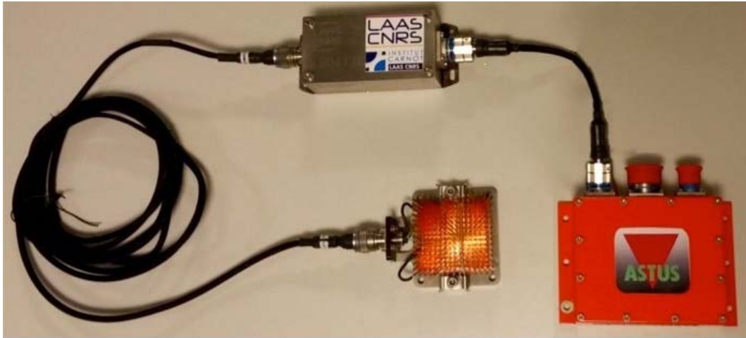
Figure 172. Photo du dispositif d'essai d'intégration. Le TEG est connecté au HMEC (libellé « LAAS ») qui alimentera le HMSS (libellé "ASTUS").
