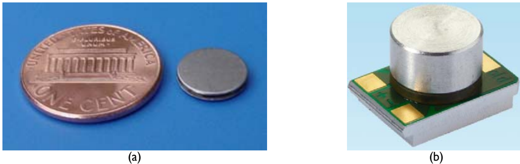
Figure 117. Deux thermogénérateurs à couche mince. (a) est un thermogénérateur de la taille d'un pile bouton fabriqué par Thermo Life [172]. (b) est un thermogénérateur de Micropelt avec un dissipateur cylindrique en aluminium pour évacuer la chaleur du côté froid [104].
