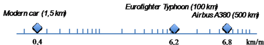
Figure 41. Echelle du haut : longueurs totales des câbles électriques dans une automobile moderne, un avion de combat et un avion de ligne. Echelle du bas, longueurs totales ramenées à la longueur de l'objet considéré (respectivement 3m80, 16m et 73 m).
