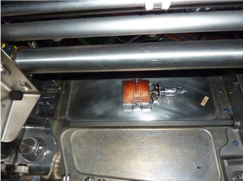
Figure 174. Le module thermogénérateur fixé dans le mât réacteur de l'A380 d'essai, non connecté au reste du système.
