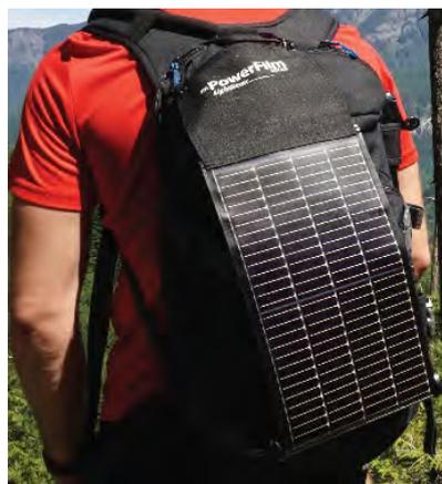
Figure 55. Module PowerFilm® en a-Si pour recharger des appareils électroniques portatifs [138].
