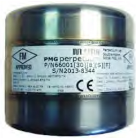
Figure 28. Photo d'un module de récupération électromagnétique de vibration de Perpetuum Ltd et valeurs de puissance récupérée annoncées par le constructeur. Le module pèse 1 kg et mesure 7cm*6,5cm. La fréquence nominale du récupérateur est réglable par l'utilisateur [89].
