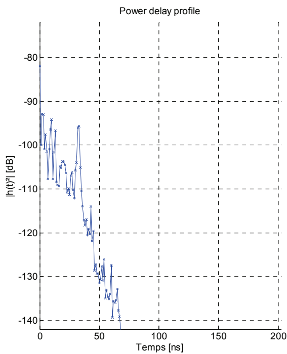
Figure 2.19 – Power delay profile pour 100 réalisations et un exemple de réponse impulsionnelle avec l'angle d'arrivée des trajets pour l'environnement residential LOS avec un angle d'ouverture de 360^\circ pour l'antenne d'émission et 15^\circ pour l'antenne de réception. Le delay spread moyen est de 1,72 ns et le delay spread RMS est de 3,45 ns.
