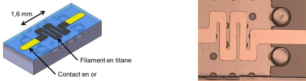
Figure II.13 : (à gauche) Schéma du filament et des contacts en or déposés sur une membrane polymère avant le dépôt de nanothermite ; (à droite) Photo du filament en titane réalisé selon le procédé développé dans la thèse de G. Taton.
