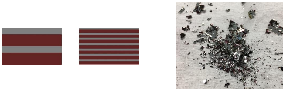
Figure III.2 : Schéma démonstratif de la différence entre des couches micrométriques (à gauche) et nanométriques (au centre) ; (à droite) Photo de flocons Al / CuO.
