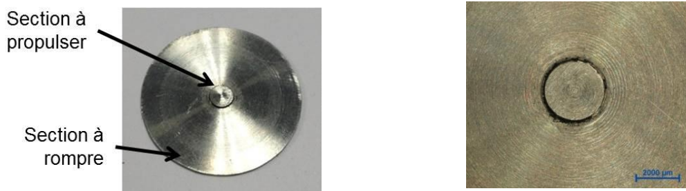
Figure IV.5 : (à gauche) Photo vue d'ensemble du paillet ; (à droite) Zoom montrant la partie propulsée [IV.1].
