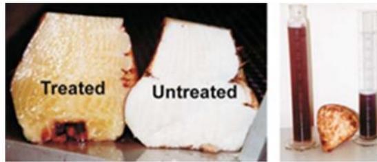
Figure 12: Coupes des betteraves avant et après traitement avec le champ électrique, avec le rendement en jus obtenu correspondant [58].
