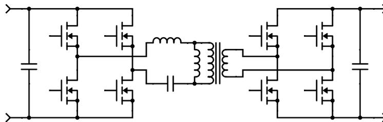
FIGURE 3.2.3 – Schéma électrique de base de la topologie LLC avec primaire et secondaire en pont complet
