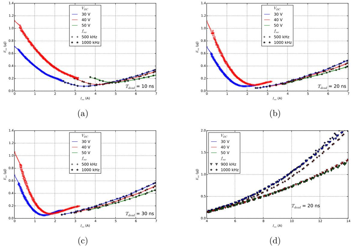
FIGURE 2.3.8 – Courbes expérimentales de pertes par commutation pour une jambe de EPC2001 : (a)-(c) mesures composites sur la gamme  $0 < I_{sw} \leq 7$  A ; (d) mesures à  $I_{sw}$  élevé acquises à deux fréquences différentes
