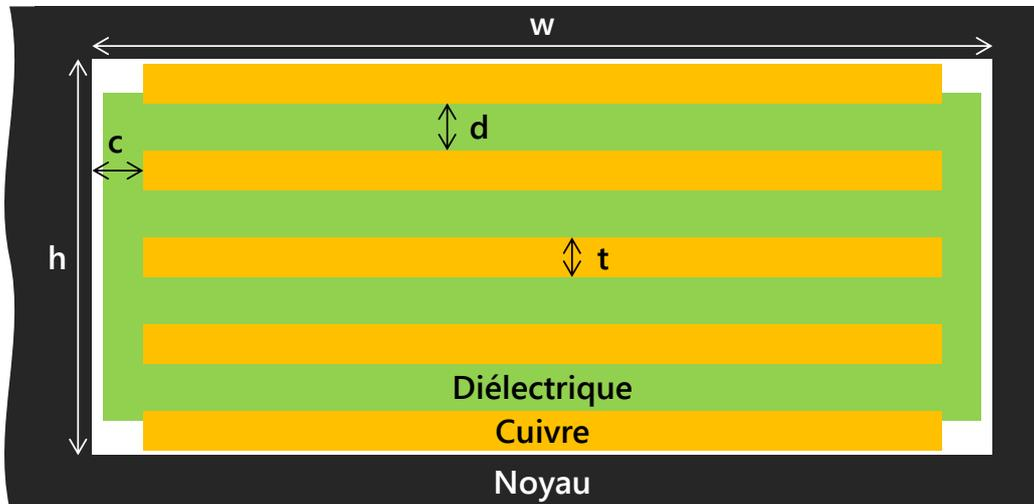
FIGURE 3.3.1 – Paramètres dimensionnels définissant un enroulement « planar »
