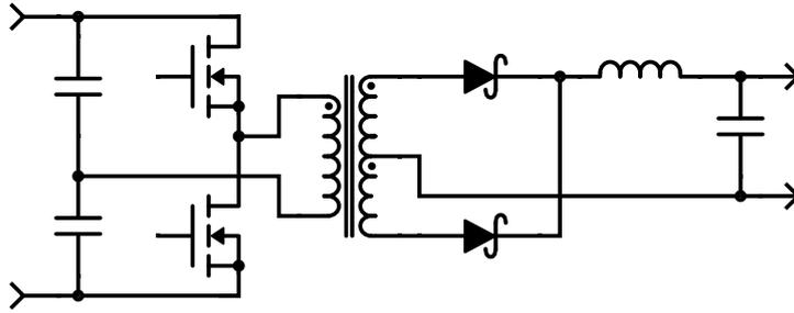
FIGURE 4.2.9 – Schéma électrique de base de la topologie demi-pont
