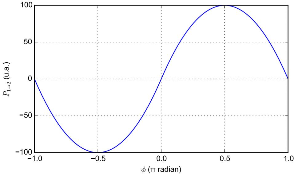
FIGURE 3.2.5 – Puissance transférée par le convertisseur DAB idéal en fonction du déphasage
