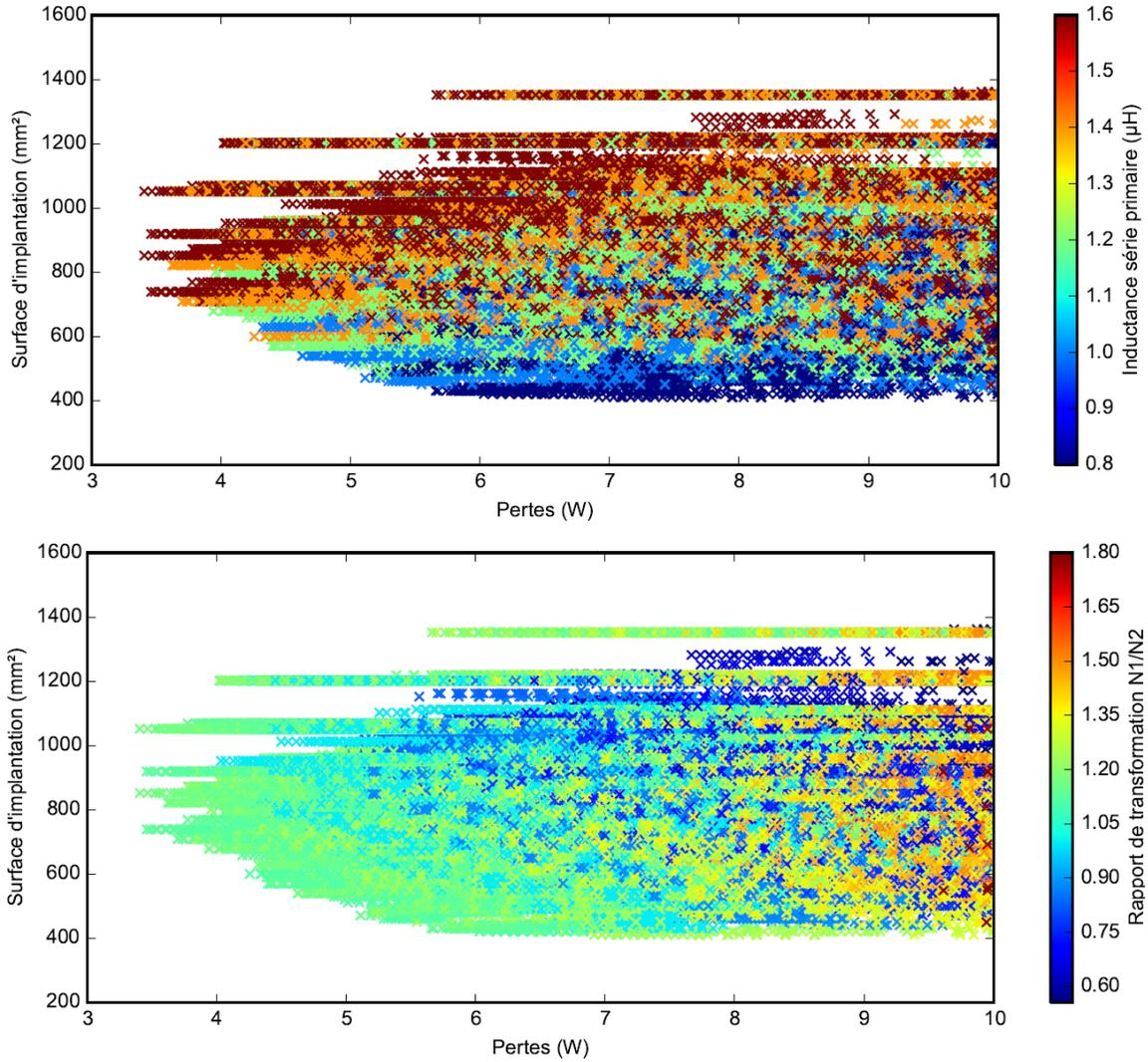
FIGURE 3.3.3 – Représentation des variantes de design valides dans le plan pertes-encombrement
