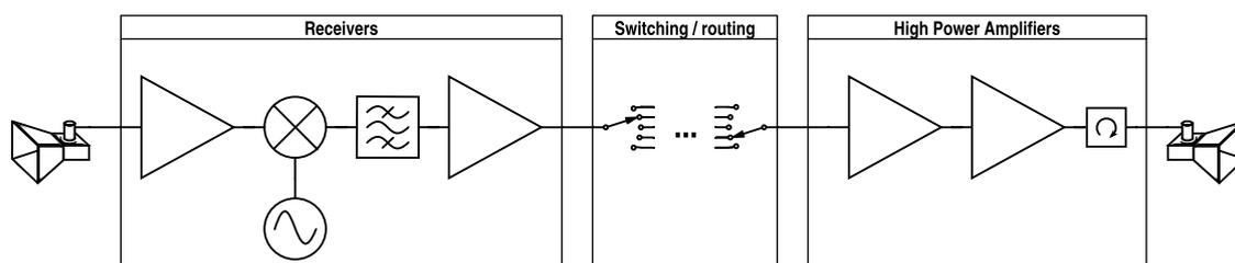
FIGURE 1.1.3 – Chaîne radiofréquence typique d'un satellite de télécommunications
