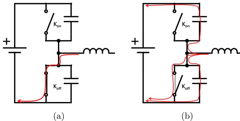
FIGURE 2.4.5 – Blocage à courant positif : (a) état initial ; (b) transfert du courant
