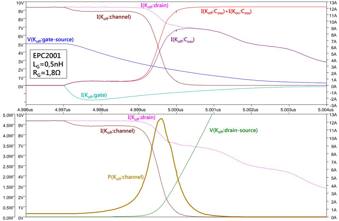
FIGURE 2.4.6 – Simulation du blocage d’un EPC2001 à  $I_{sw} \approx 12$  A
