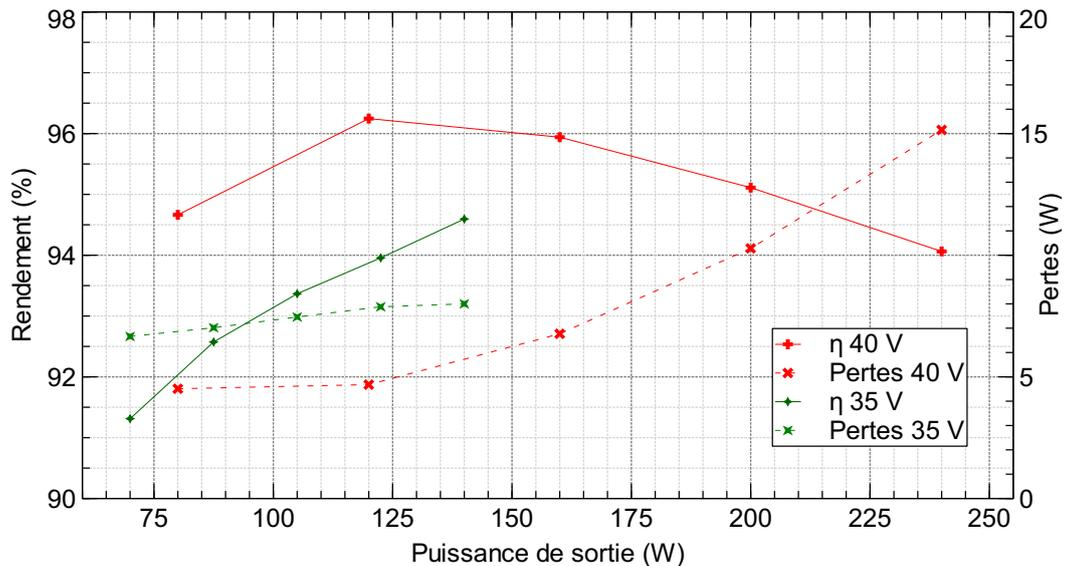
FIGURE 3.4.5 – Rendements obtenus avec le prototype de DAB dans la configuration ER23 7 : 6 non-entrelacé +  $1\text{ }\mu\text{H}$
