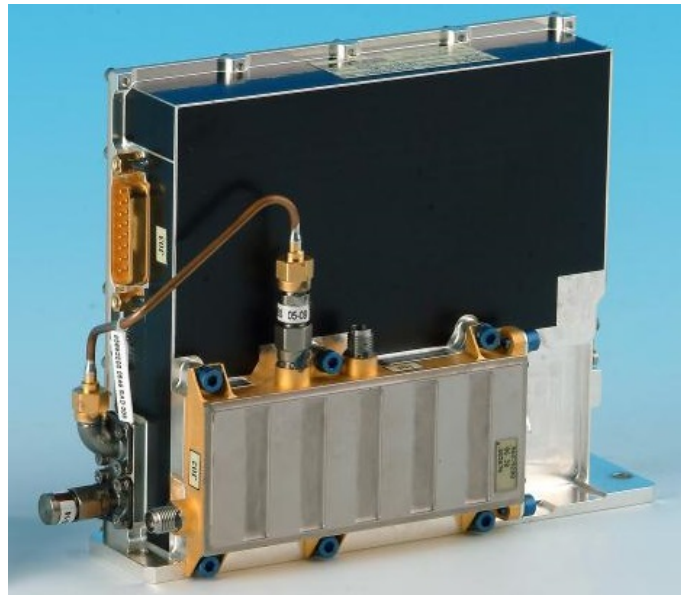
FIGURE 1.1.4 – Récepteur RF complet, rassemblant les boîtiers de différents éléments (photo THALES ALENIA SPACE)
