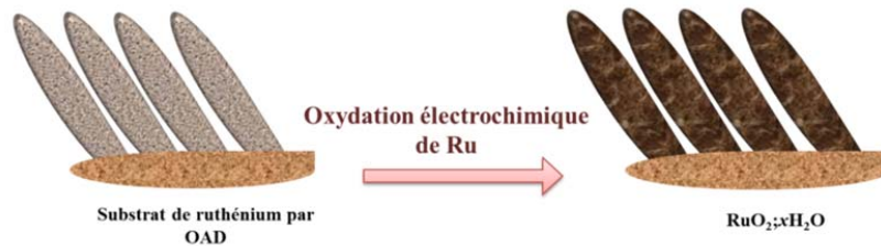
Figure II.15 : Représentation schématique de l'oxydation du ruthénium métallique après dépôt par OAD.
