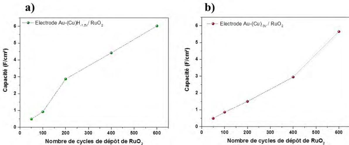
Figure IV.30: Evolution de la capacité de l'électrode Au-(Cu)H / RuO<sub>x</sub> a) à -1,5 V et b) -3 V vs. ECS en fonction du nombre de cycles de dépôt d'oxyde de ruthénium.
