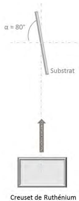
**Figure II.16: Représentation schématique du montage de dépôt de ruthénium métallique par OAD avec un angle d'incidence de  $80^\circ$ .**
