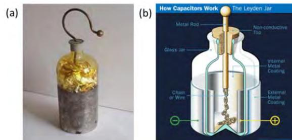
Figure I.1: a) Photographie [1] et b) représentation schématique de la bouteille de Leyde [2].
