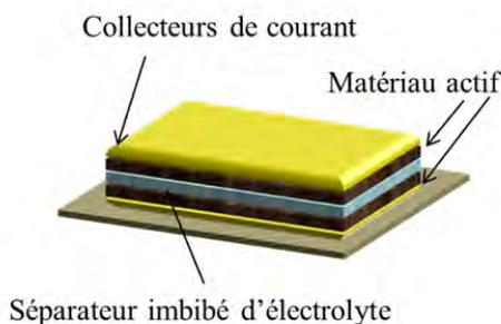
Figure V.1: Représentation schématique du micro-supercondensateur en configuration empilée.
