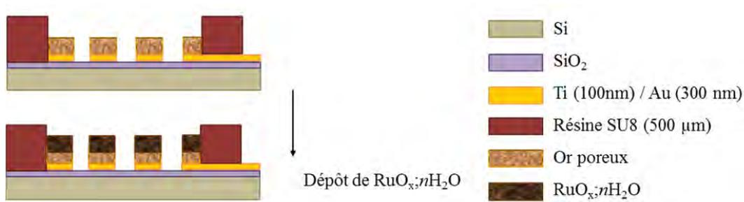
Figure V.17: Etape de fabrication de l'électrode à base d'oxyde de ruthénium.
