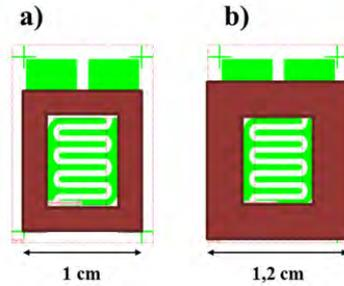
Figure V.25: Représentation schématique du dispositif a) avec une cuve de SU8 déposée sur l'or et b) élargie sur le Si/SiO<sub>2</sub>.
