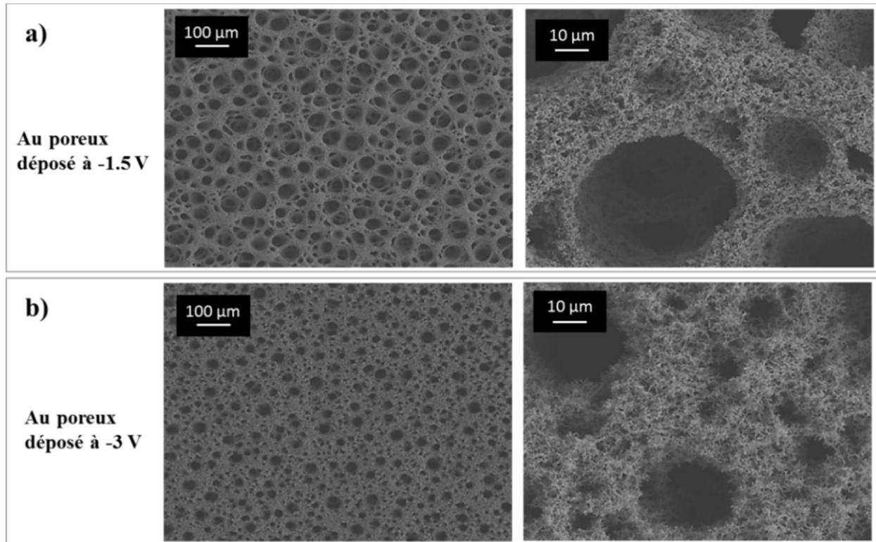
Figure IV.9 : Images MEB de la structure d'or poreuse déposée à a) -1,5 V et b) à -3 V vs. ECS.
