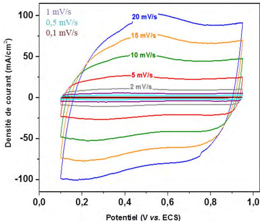
Figure IV.29: Voltammétrie cyclique de l'électrode Au-Cu)H / RuO<sub>x</sub> 400 cycles à différentes vitesses de balayage.
