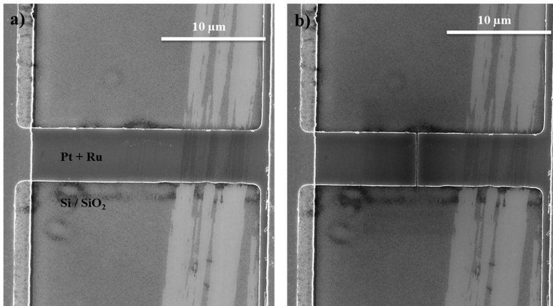
Figure III.10 : Image au microscope électronique des nano-supercondensateurs
