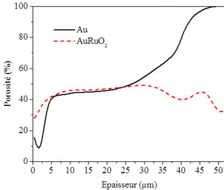
Figure IV.23 : Profil de porosité des deux échantillons AuH et AuH/RuO<sub>x</sub>.
