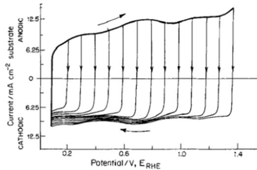
Figure I.12: Voltammogramme cyclique d'une électrode de RuO<sub>2</sub> dans une solution d'acide sulfurique à 50 mV/s [33].
