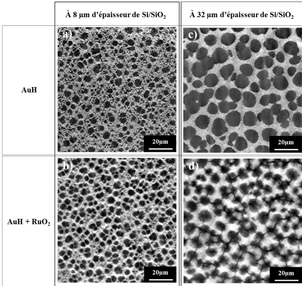
Figure IV.22: Tomogrammes à c) & d) 8  $\mu\text{m}$  et e) & f) 32  $\mu\text{m}$  d'épaisseur à partir du substrat Si pour les échantillons AuH et AuH + RuO<sub>x</sub>.
