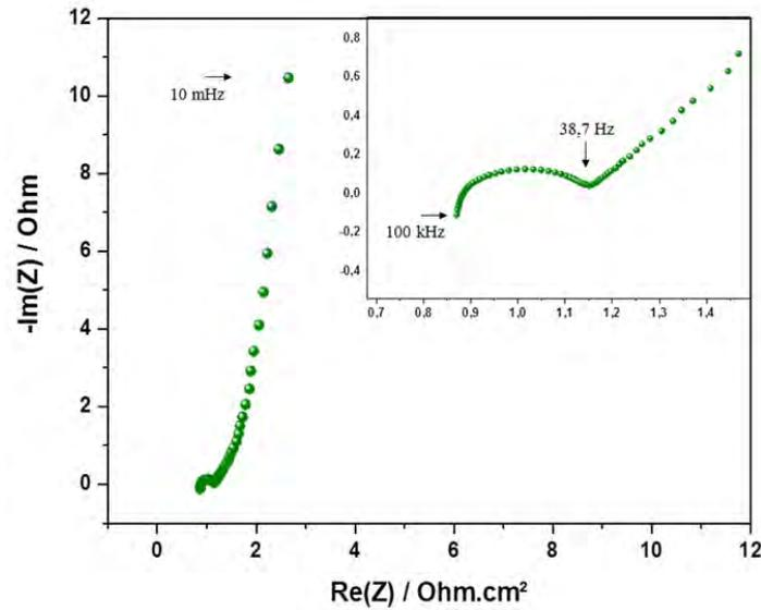
Figure IV.32: Spectroscopie d'impédance électrochimique de l'électrode Au-(Cu)H / RuO<sub>x</sub>
