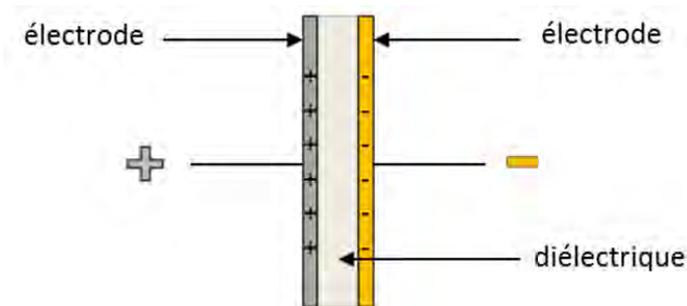
Figure I.3: Représentation schématique d'un condensateur électrostatique classique.
