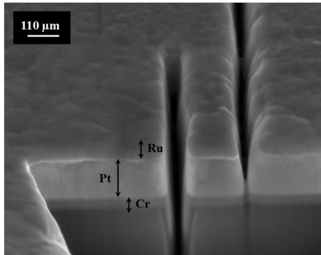
Figure III.9: Image au microscope des essais de gravures ionique en profondeur
