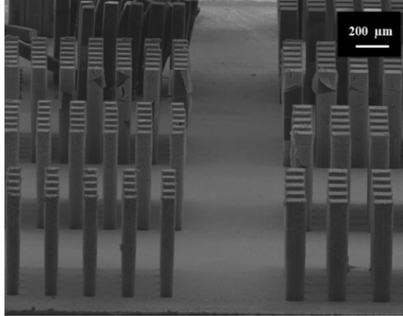
Figure IV.33: structure de plots de résine recouverts d'or.
