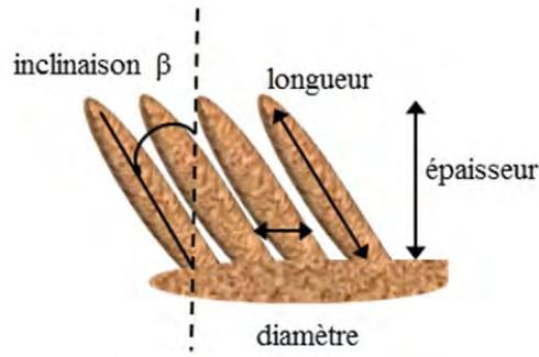
Figure II.7: Représentation schématique du dépôt colonnaire par OAD.
