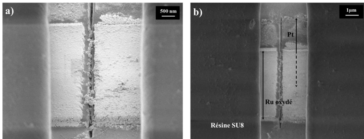
Figure III.14: Image de la morphologie du nano-supercondensateur.
