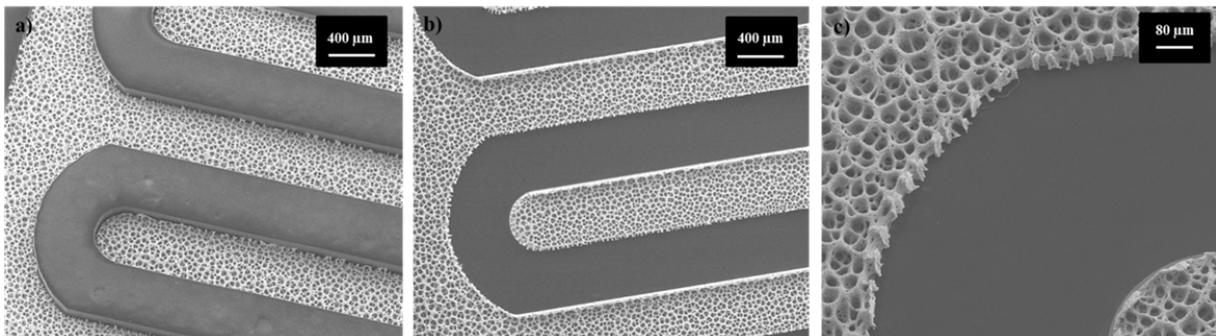
Figure V.23: Morphologie du dépôt d'or poreux a) avec les murs de résine BPN, b) & c) après retrait de la résine sacrificielle.
