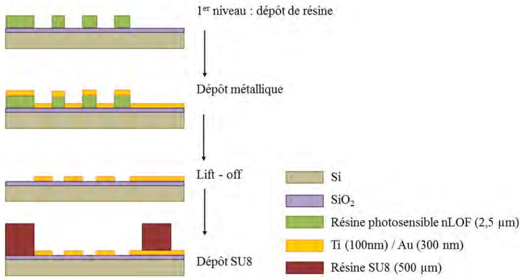
**Figure V.14: Etapes photolithographiques nécessaires à la conception de la base du dispositif.**
