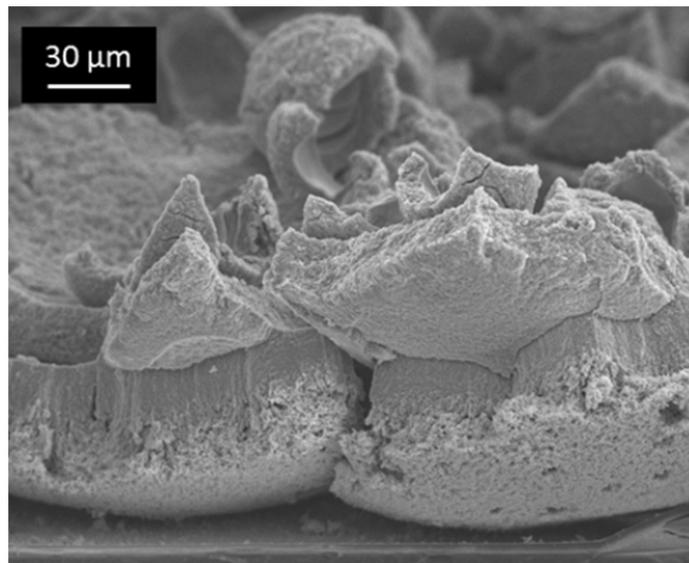
Figure IV.28: Image MEB de l'électrode Au-(Cu)H à -1,5 V vs. ECS avec 600 cycles de dépôt de RuO<sub>x</sub>.
