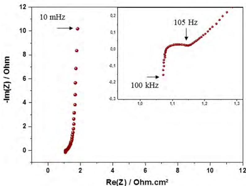
Figure IV.27: Spectroscopie d'impédance électrochimique de l'électrode AuH / RuO<sub>x</sub>.
