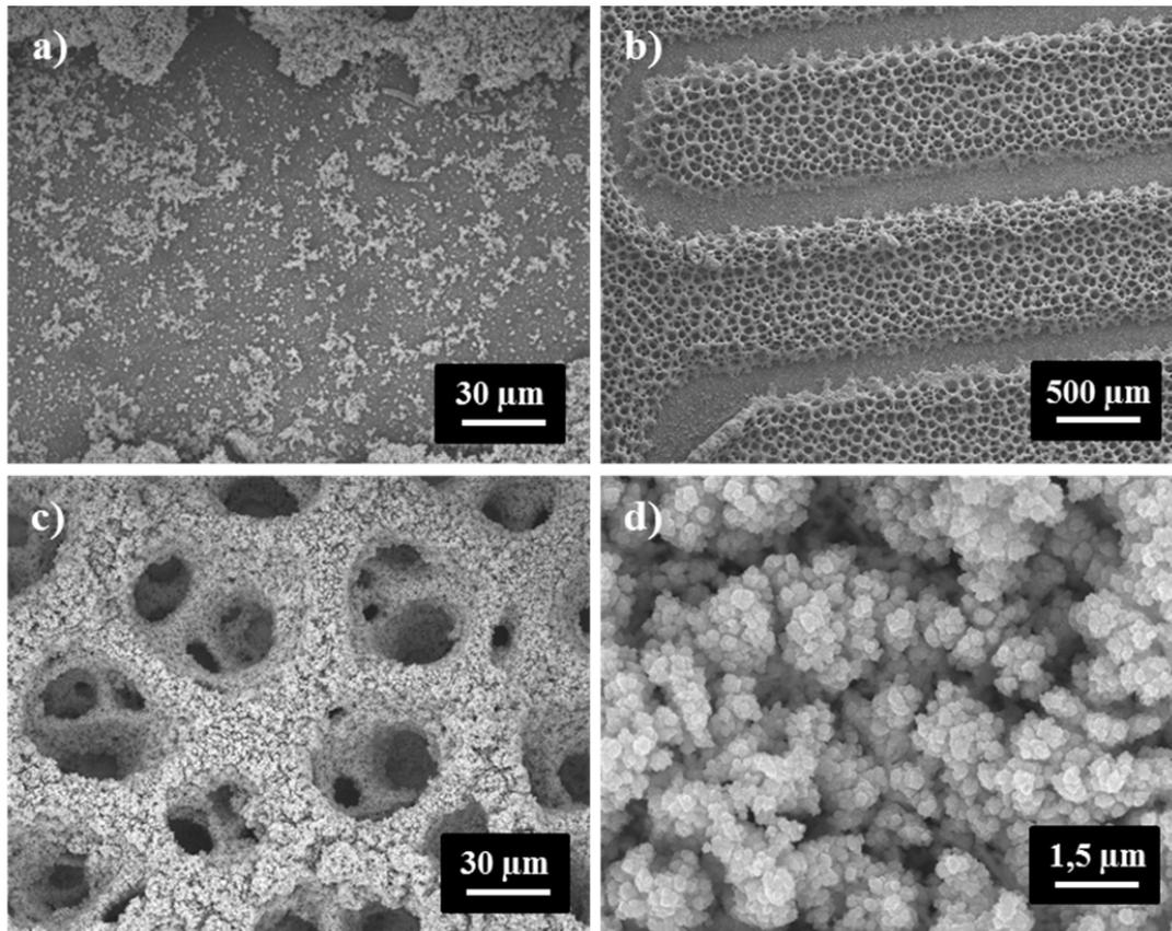
Figure V.18: a) & b) Présence de dépôt chimique dans l'interespace et morphologie du dépôt d'oxyde de ruthénium c) et d) sur les électrodes interdigitées.
