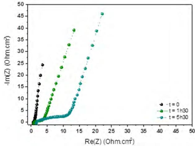
Figure V.7: Diagramme de Nyquist de l'évolution de l'impédance en fonction du temps de repos de l'électrolyte polymère.
