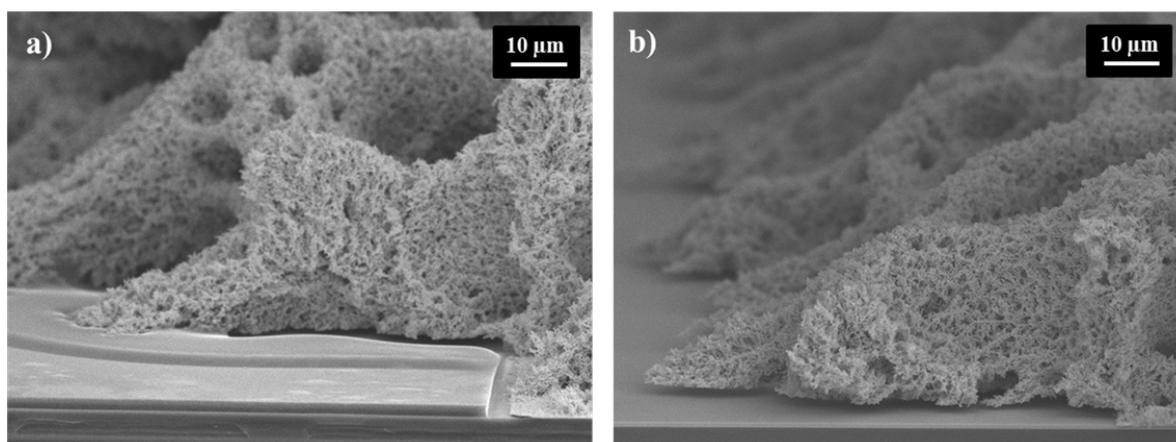
**Figure V.20: Structure d'or poreux a) avec résine sacrificielle dans l'interespace et b) après le retrait de la résine sacrificielle LOR.**
