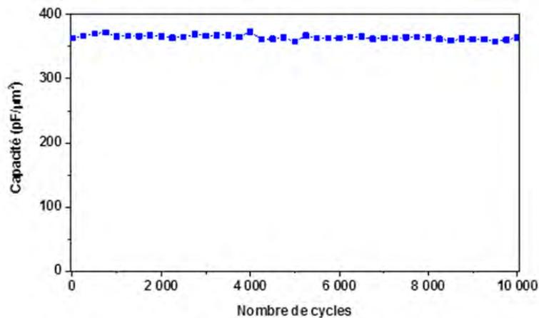
Figure III.19: Rétention de capacité en fonction du nombre de cycles de charges / décharge
