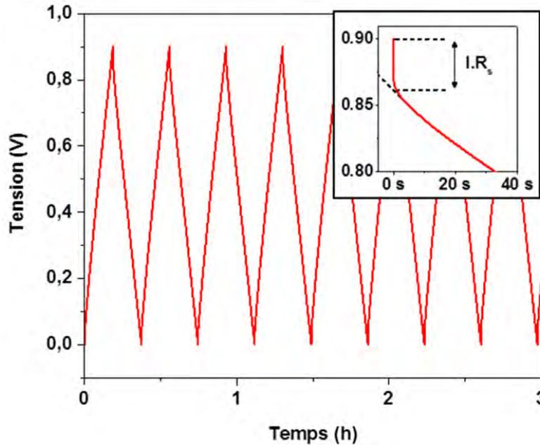
**Figure V.9:** Cycles galvanostatiques de charges / décharges du dispositif pour  $i = 1,5 \text{ mA/cm}^2$  sur une plage de tension de 0,9 V.
