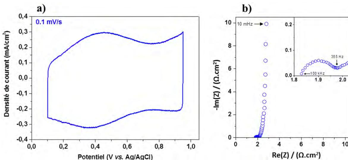
Figure V.5: a) Voltammogramme cyclique à  $0,1 \text{ mV/s}$  et b) spectroscopie d'impédance électrochimique de l'électrode à base d'oxyde de ruthénium.
