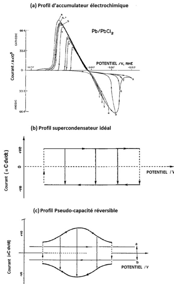
Figure I.11: Signatures électrochimiques a) d'un matériau d'accumulateur Pb/PbCl<sub>2</sub>, b) d'un matériau capacitif idéal et c) d'une pseudo-capacité [34].
