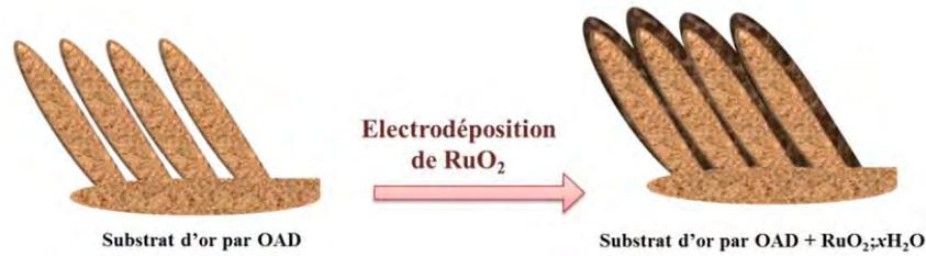
**Figure II.11: Représentation schématique du dépôt électrochimique d'oxyde de ruthénium.**
