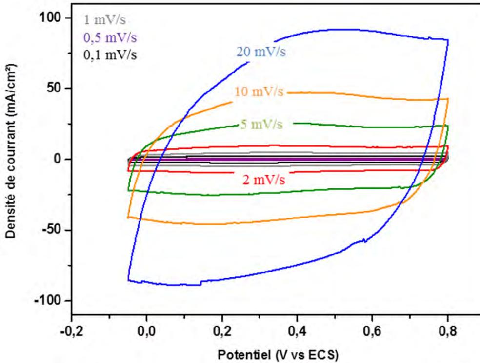
Figure IV.24: Voltammogrammes cyclique de l'électrode à base d'oxyde de ruthénium à différentes vitesses de balayage.
