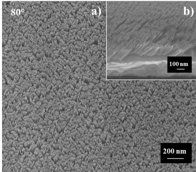
**Figure II.17: Image par microscopie électronique à balayage de la structure de ruthénium déposée par OAD a) en surface, et b) en coupe.**
