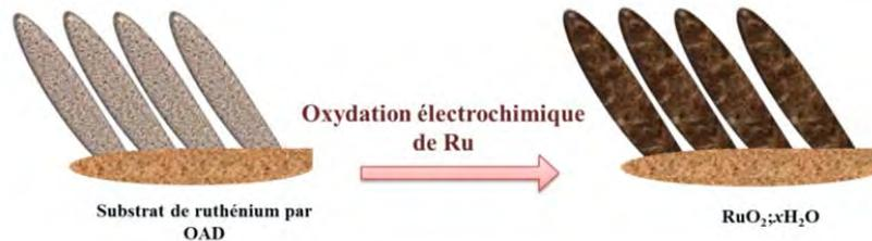
Figure II.15 : Représentation schématique de l'oxydation du ruthénium métallique après dépôt par OAD.
