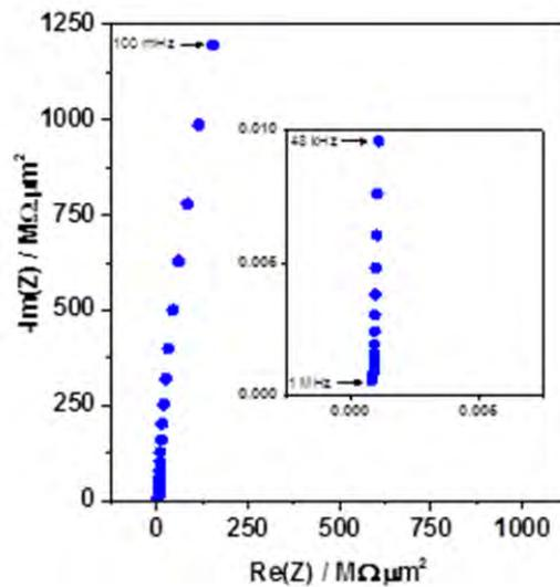
Figure III.16: Diagramme de Nyquist du nano-supercondensateur
