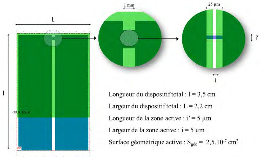
**Figure III.1: Représentation schématique et spécification du dispositif nanométrique.**
