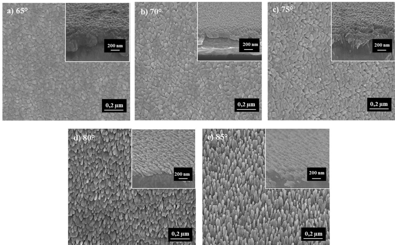
**Figure II.6 : Images par microscopie électronique à balayage avec l'évolution de la morphologie de la structure d'or en fonction de l'angle du flux incident  $\alpha$ .**
