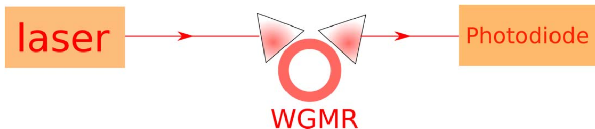
Figure 18 : Schéma expérimental pour la génération d'un peigne de fréquences par effet Kerr
