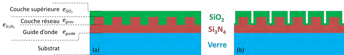
Figure 104 : Morphologies potentielles après recouvrement du réseau de Si 3 N 4 (rouge) par de la silice (couche verte). (a) Recouvrement uniforme et (b) recouvrement avec interstices.
