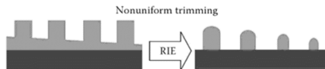
Figure 29 : Schéma illustrant les effets d'une épaisseur non uniforme de la couche résiduelle sur la gravure de cette dernière [80].
