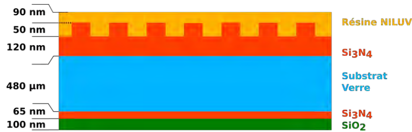
Figure 120 : Profil d'un CRIGF NIR nouvelle génération encapsulé de résine NILUV.
