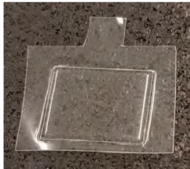
Figure 60 : Photographie montrant un moule souple après TNIL avec la languette pour faciliter le démoulage. On peut remarquer que le moule souple a épousé les contours du moule dur.
