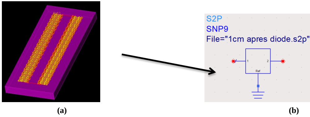
Figure III-23. (a) simulation électromagnétique de la ligne de transmission CPS (Visualisation 3D sur Momentum) et (b) Boite de paramètres S.
