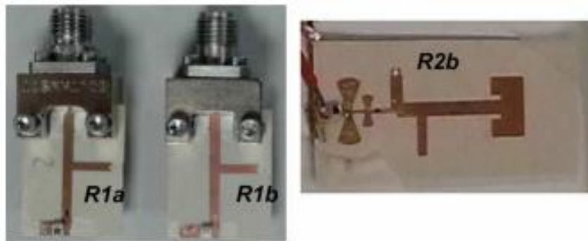
Figure I-24 photos de redresseurs R1a et R1b et d'une rectenna R2b [28]
