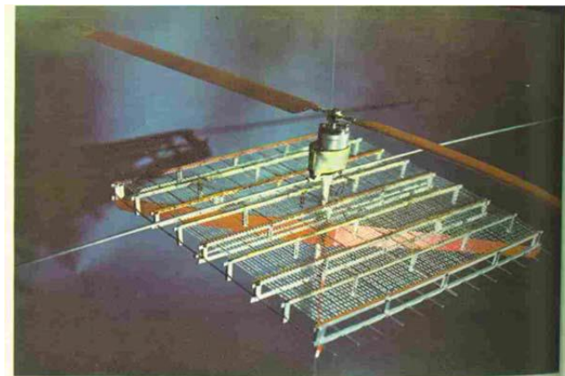
Figure I-2. Hélicoptère alimenté par de l'énergie microonde [4]
