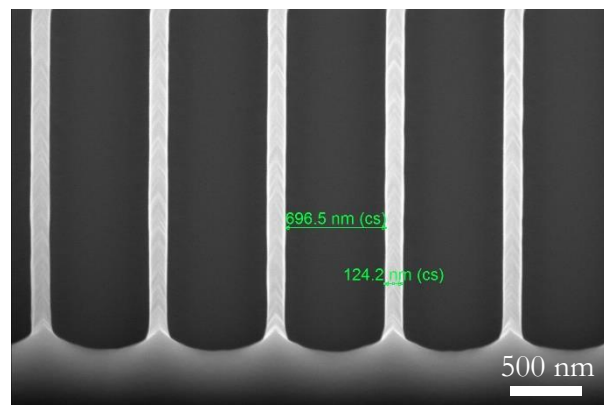
Figure 128 : réseau de rubans de résine dont les dimensions ont été réduites par sur-gravure de la couche de BARC.
