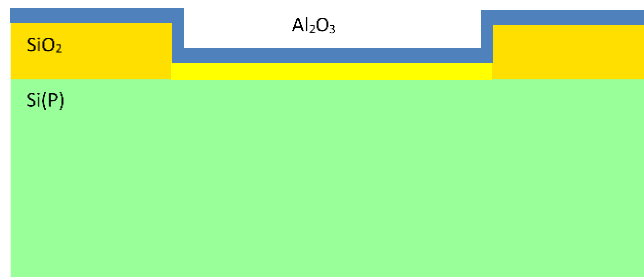
Figure 76 : schéma en coupe de la plaquette après réalisation de l'isolant
