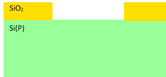
Figure 75 : schéma en coupe de la plaquette après ouverture de l'oxyde.
