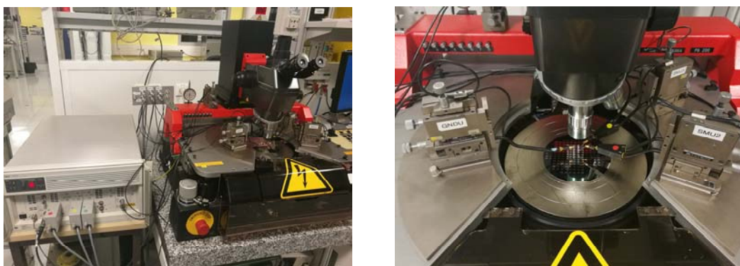
Figure 132 : station de mesures sous pointes avec le traceur Agilent 4142B
