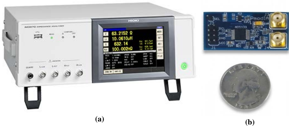
Figure 2.22 : (a) Analyseur d'impédance Hioki IM3570 et (b) carte de développement PMODIA
