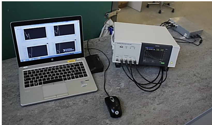
Figure 2.20 : Image de l'analyseur d'impédance piloté par un PC à l'aide de LabVIEW
