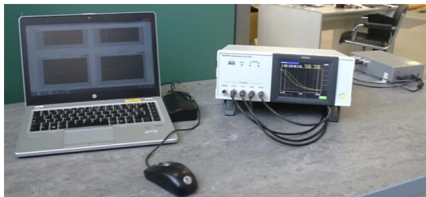
Figure 2.8 : Analyseur d'impédance piloté par l'interface LabVIEW sur PC
