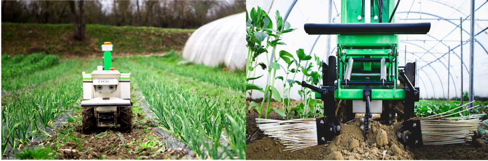
FIGURE 4.1 – Robot Oz travaillant dans un champ avec ses outils. À gauche : vue de face ; à droite : vue de dos.
