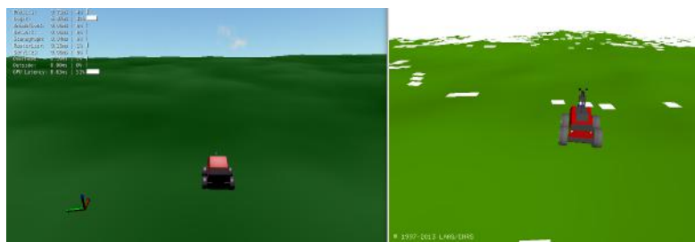
FIGURE 1.4 – À gauche le robot dans le monde simulé par MORSE, à droite la représentation que le robot a de son environnement. Les zones blanches correspondent à des parties non perçues.
