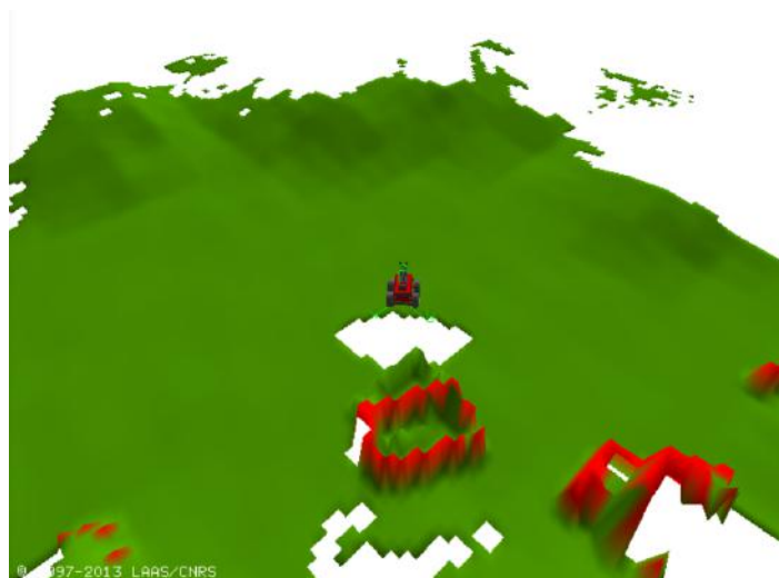
FIGURE 1.2 – Exemple d’un modèle numérique de terrain obtenu avec le module GenoM DTM.
