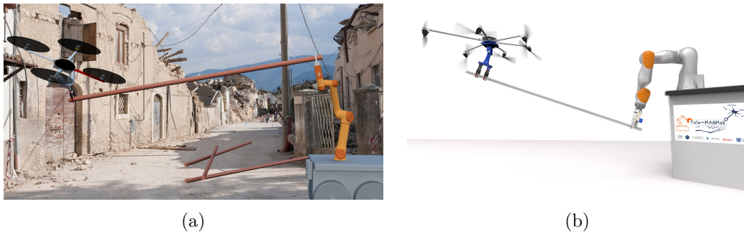
FIGURE B.9 – Cas d’utilisation potentiels pour MAGMaS de composition différente. Reste (a) dans un scénario USAR avec une base mobile et un AR sous-exploité nettoyant les buildings. Droite (b) dans un scénario de mise hors service avec un robot terrestre fixe et une poussée multidirectionnelle manipulant un tube en coopération.
