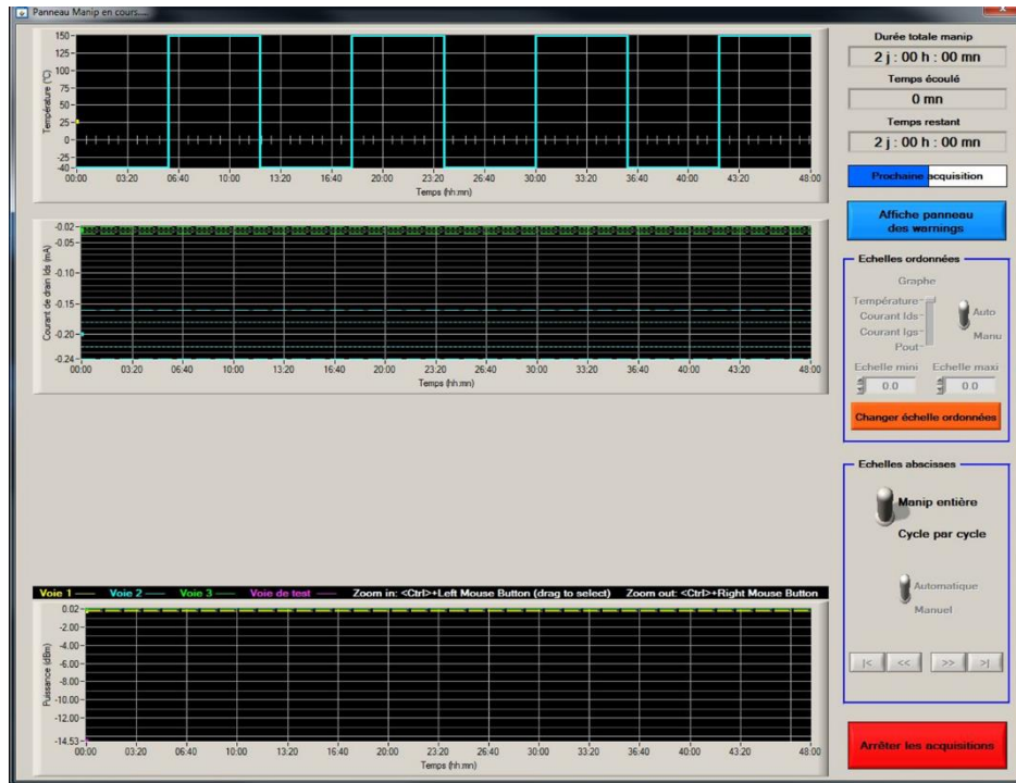
Figure II. 9 : fenêtre de visualisation de l'évolution des paramètres des différentes voies : température, I_{DS} et P_{OUT} .
