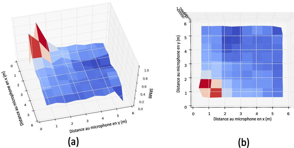
FIGURE 3.4 – Évolution du SRMR en fonction de la distance au microphone en vue 3D en (a) et zénithale en (b)
