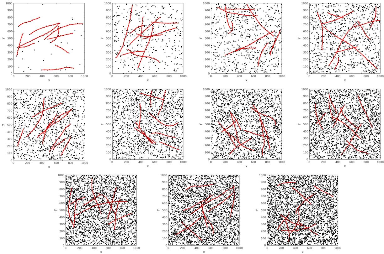
FIGURE 4.6 – De haut-gauche à bas-droit : scénarii de test comportant 10 trajectoires, générées aléatoirement, à plusieurs taux de fausses alarmes par temps et par volume :  $\lambda_b V = [1, 10, 20, 30, 40, 50, 60, 70, 80, 90, 100]$ .
