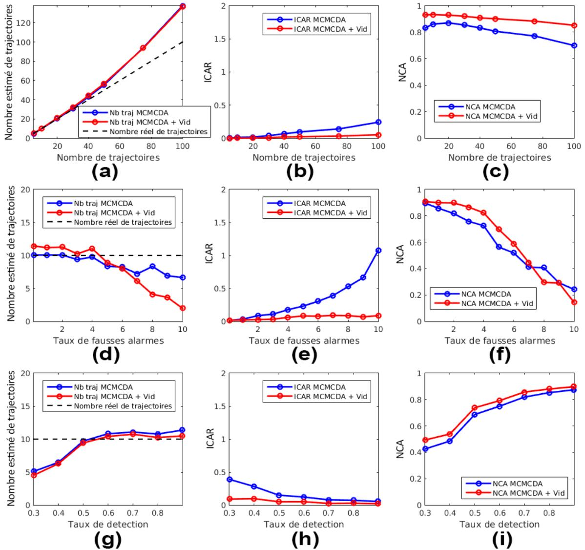
FIGURE 4.11 – Comparaison des résultats de l’approche MCMCDA avec modèle dynamique seul (courbes bleues) et en ajoutant un modèle d’apparence visuelle (courbes rouges).
