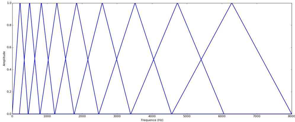
FIGURE 2.6 – Réponse fréquentielle d’une banque de 10 filtres suivant l’échelle perceptuelle Mel sur l’espace fréquentiel [0-8000Hz].
