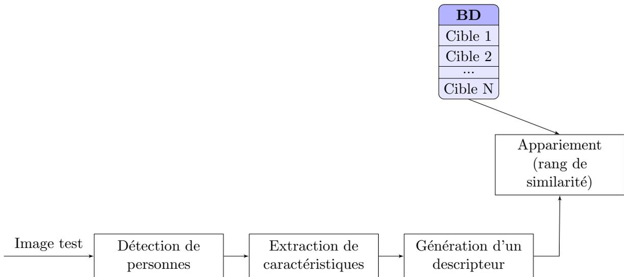
FIGURE 1.3 – Synoptique d’un système de ré-identification traditionnel.
