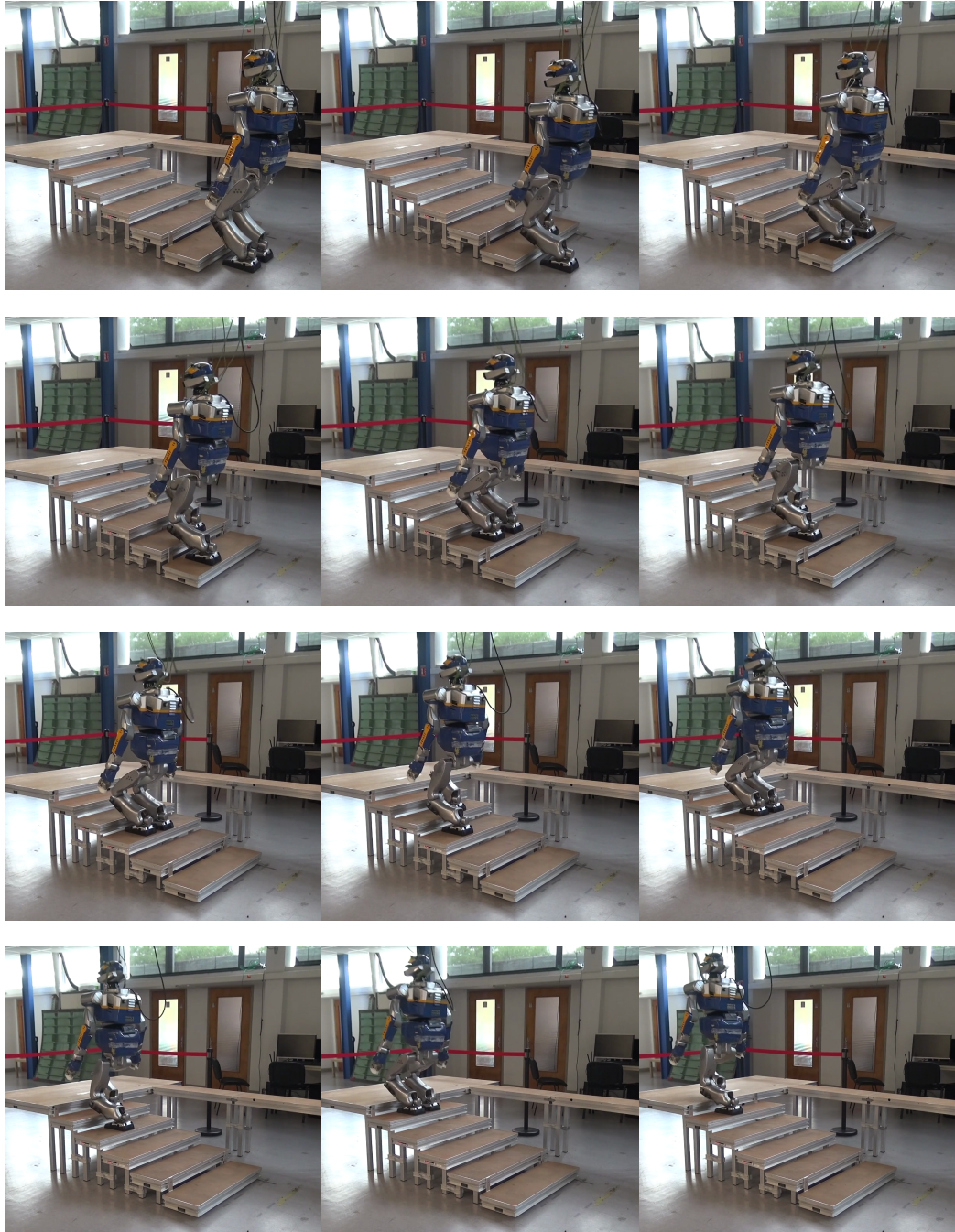
FIGURE 7.11 – Captures du mouvement corps complet réalisé par le robot HRP-2 pour le scénario de la montée des marches.
