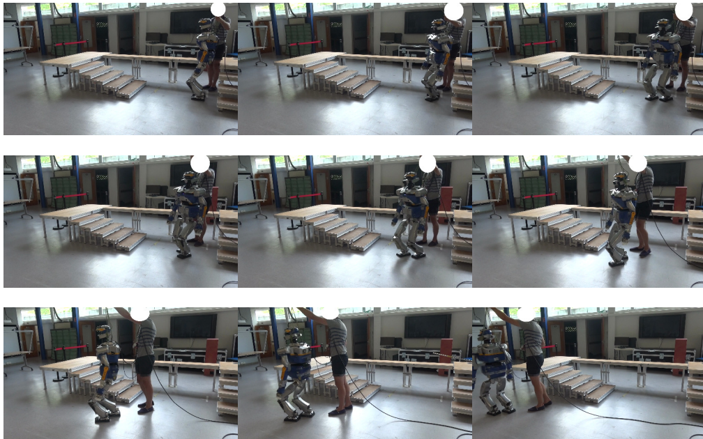
FIGURE 7.4 – Captures du mouvement corps complet exécuté sur le robot HRP-2 pour le scénario de navigation sur sol plat.
