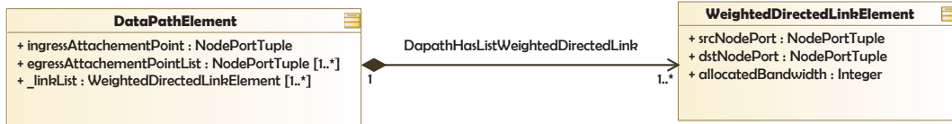
(b) Modèle d'un chemin de données
