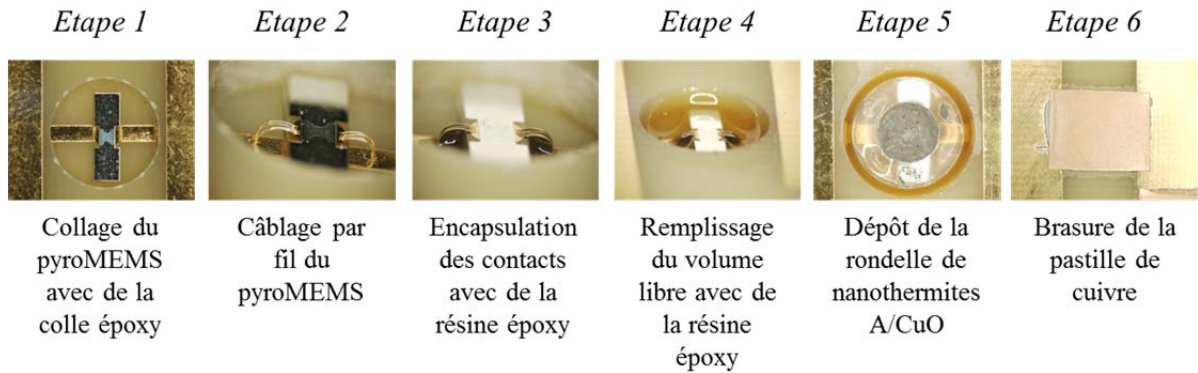
Figure IV.22 : Images illustrant les principales étapes d'assemblage du sectionneur.
