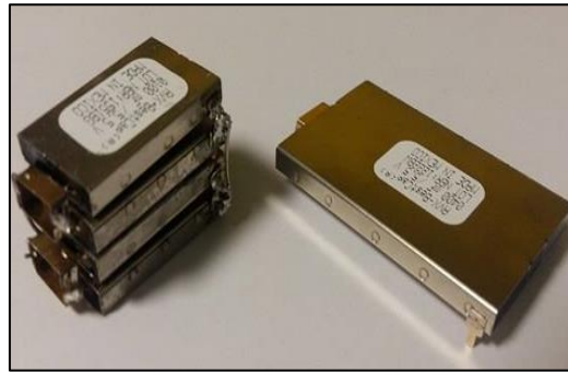
Figure 2-32 : Illustration des quatre cellules élémentaires en parallèle à gauche et le supercondensateur unique de capacité équivalente à droite.
