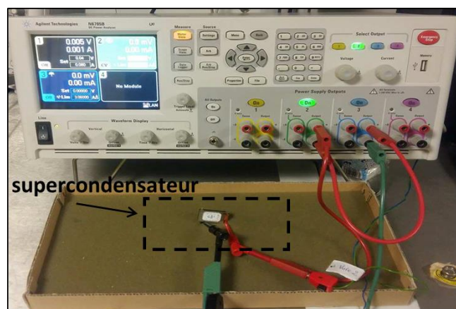
Figure 2-21 : L'analyseur de puissance (Keysight N6705B) utilisé pour les mesures des supercondensateurs à courant constant [52].
