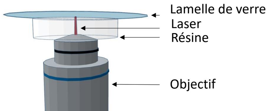
**Figure 2 :** La lamelle de verre sur laquelle est déposée la résine (IP-Dip) est retournée sur le porte échantillon. L'objectif est en contact avec la résine. Cette dernière sert également de milieu d'immersion.
