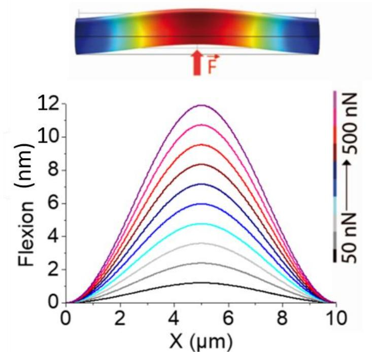
**Figure 9 : Simulation pour déterminer la raideur d'une poutre.** Au-dessus, une poutre de 1.5 μm de diamètre et de 10 μm de longueur dont les deux extrémités sont encastrées se déforme sous l'action d'une force normale à la surface de la poutre appliquée au centre de celle-ci. Sur le graphique est représentée la déformée de la poutre en fonction de l'amplitude de la force appliquée. Les forces appliquées vont de 50 à 500 nN par pas de 50 nN.
