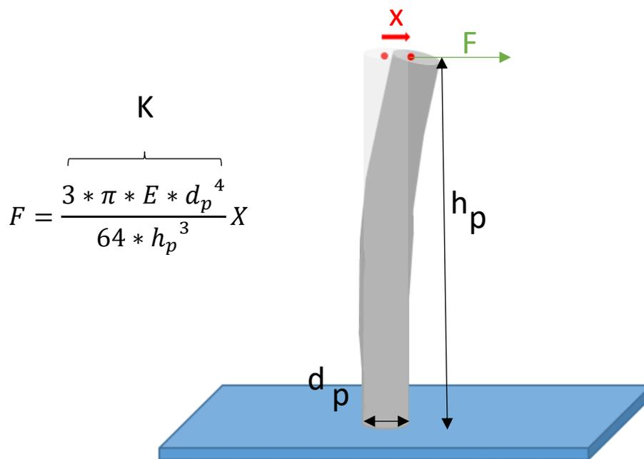
Figure 7 : Schéma de la flexion d'une poutre cylindrique encastrée de diamètre  $d_p$ , de hauteur  $h_p$ , sous l'action d'une force ( $F$ ) appliquée à son extrémité. La poutre est composée d'un matériau de module d'Young  $E$ . La flèche  $X$  est reliée à la force par le facteur  $K$ .
