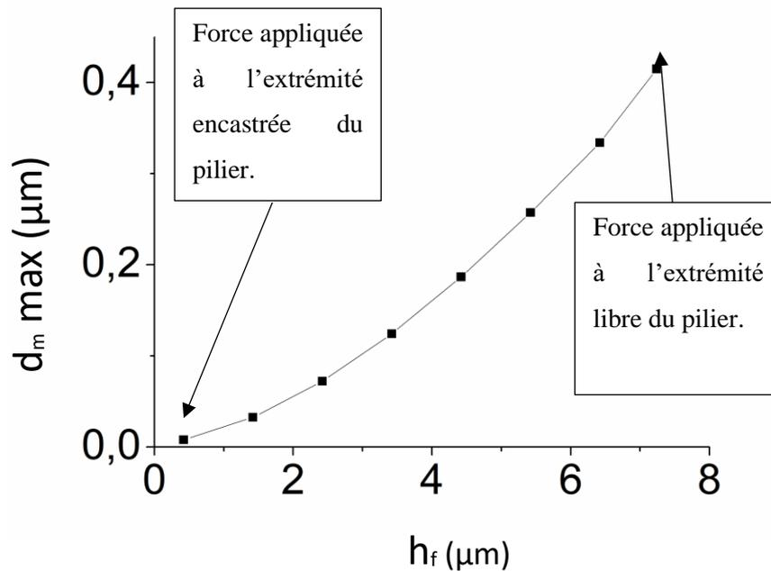
**Figure 8 : Flexion d'un pilier encastré.** Le déplacement de l'extrémité libre du pilier ( $d_m \text{ max}$ ) est tracé en fonction du positionnement sur l'axe z ( $h_f$ ) du point central de la surface d'application de la force. Cette surface est celle d'un demi cylindre de hauteur  $1 \mu\text{m}$  et de rayon identique à celui du pilier (voir texte).
