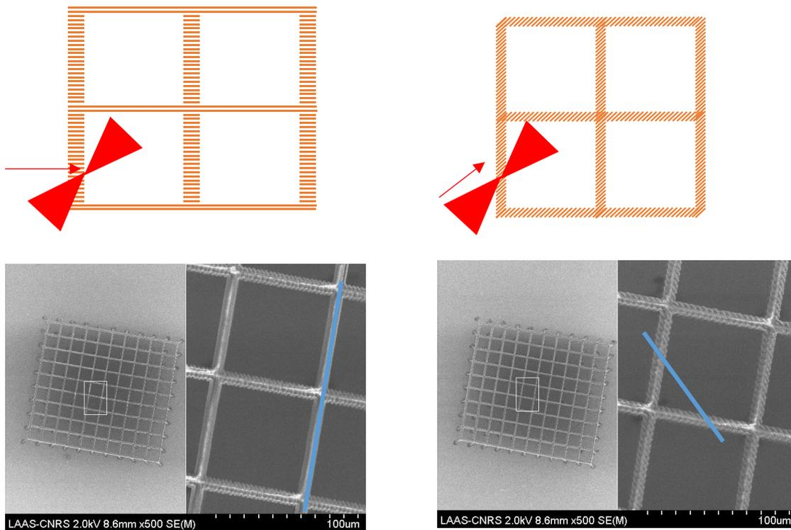
**Figure 4 : Anisotropie de polymérisation.** A gauche, la direction de polymérisation, indiquée par la ligne bleue, est parallèle à des poutres et perpendiculaire aux autres. A droite, l'angle entre la polymérisation et les poutres est de  $45^\circ$ , de cette manière aucune anisotropie est introduite entre les poutres des plans (X, Y).
