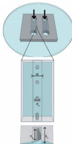
Figure 1 : Schéma du dispositif de microfluidique. En haut, dispositif complet avec les réservoirs et les deux séries de microcanaux, au milieu: zoom sur un canal équipé de piliers,  $W$  est la largeur du canal,  $d_p$  le diamètre du pilier,  $h_p$  la hauteur du pilier et  $h_c$  la hauteur du canal, en bas : vue 3D au sein d'un canal équipé de piliers monté au-dessus d'une lame de verre.
