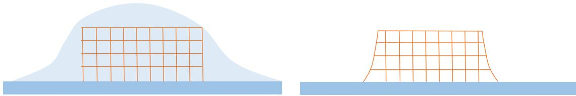
**Figure 5 : Schéma de la déformation des structures après séchage.** A gauche, la structure est encore encerclée d'éthanol et non déformée. A droite est représentée la structure après le séchage de l'éthanol, les flancs sont déformés.
