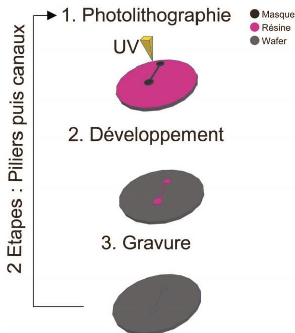
**Figure 4 : Processus de fabrication du moule.** (1) le wafer sur lequel est déposée une couche de résine positive est exposé aux UV à travers un masque. (2) La couche de résine restante sur le wafer après développement. (3) Wafer structuré après l'étape de gravure.
