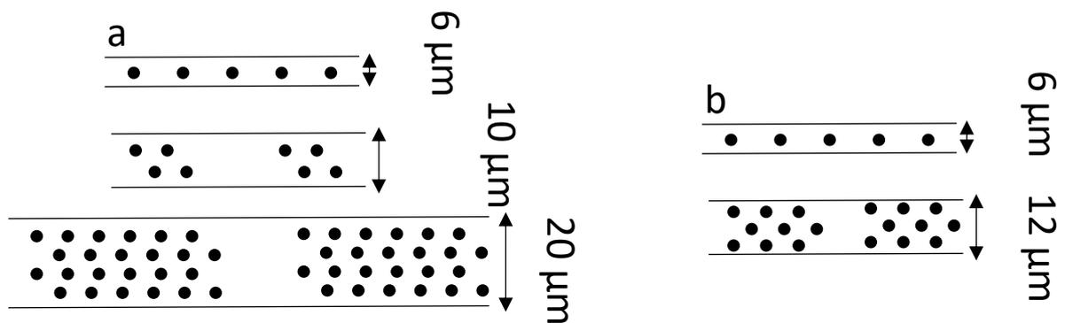
**Figure 2 : Schéma de la première et deuxième génération des canaux.** (a) Première génération de canaux équipés de piliers, schéma d'un canal de 6  $\mu\text{m}$  de large, 10  $\mu\text{m}$  de large et de 20  $\mu\text{m}$  de large. (b) Deuxième génération de canaux équipés de piliers, schéma d'un canal de 6  $\mu\text{m}$  de large et de 12  $\mu\text{m}$  de large.
