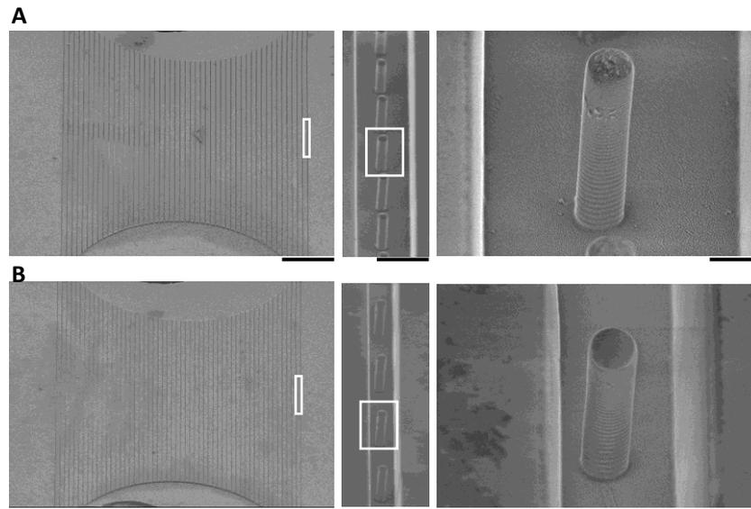
Figure 6 : Images par microscopie électronique à balayage d'un micro dispositif. À gauche, champ large de tous les canaux de 12  $\mu\text{m}$  (A) et 6  $\mu\text{m}$  (B) barre d'échelle 500  $\mu\text{m}$ , au milieu zoom sur un des canaux barre d'échelle 10  $\mu\text{m}$ , à droite zoom sur un des piliers des canaux de 12 et 6  $\mu\text{m}$  de large, barre d'échelle 2  $\mu\text{m}$ .
