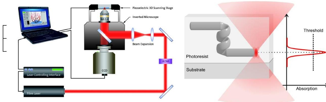
**Figure 3 : Principe de fonctionnement du Nanoscribe®.** À gauche, l'ordinateur communique avec la plateforme piézoélectrique, les miroirs galvanométriques, la caméra et le laser pour piloter la position du point focal du laser pour fabriquer la structure. À droite, schéma du laser polymérisant la résine. Adapté du manuel d'instruction du Nanoscribe®.
