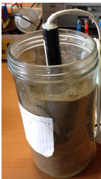
Figure 12 : Tests d'un capteur dans un pot calibré
