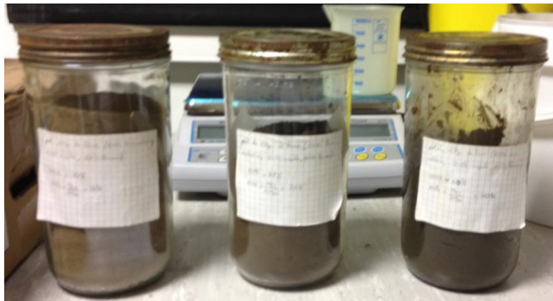
Figure 11 : Pots de stockage des échantillons de sols
