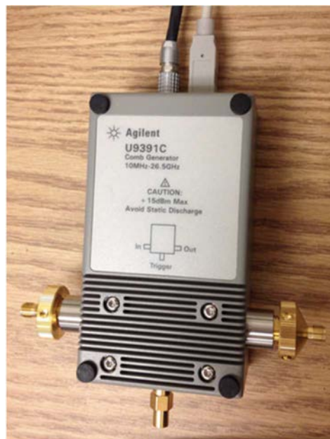
Figure 3.52: Photo du générateur d'impulsion utilisé pour la calibration de la phase [5].
