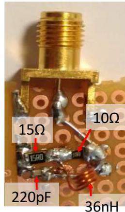
Figure 3.26: Photo du circuit RLC réalisé
